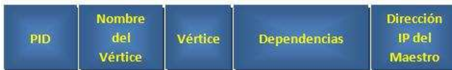
Figura 3.6. Estructura del contenedor unitario de proceso.
