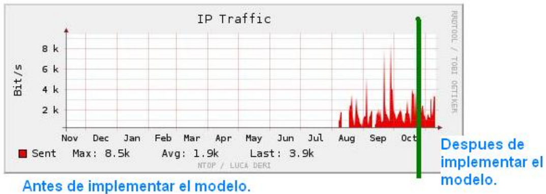
Figura 4.11. Comparativa del nivel de tráfico IP en la red antes y después de la arquitectura QoS.
