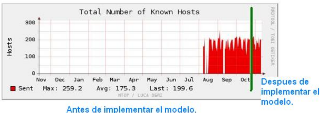
Figura 4.10. Comparativa del nivel de ocupación de la red antes y después de la arquitectura QoS.
