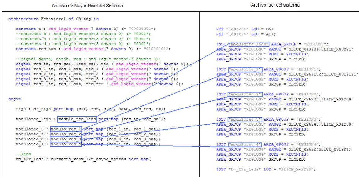
Figura 4.7. Relación de los Módulos Reconfigurables y la Restricción AREA\_GROUP.
