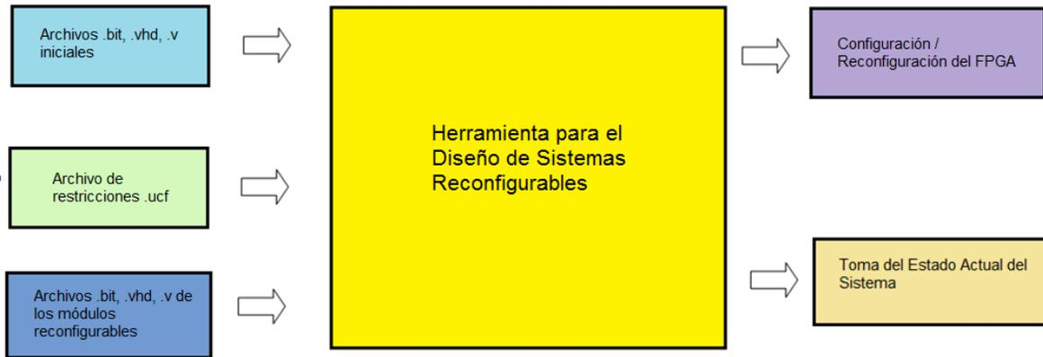
Figura 5.11. Principales Entradas y Salidas del Sistema.
