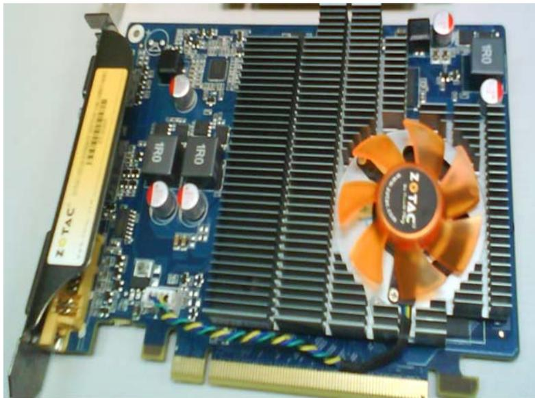
Figura 17: Tarjeta gráfica NVIDIA GeForce GT 220.
