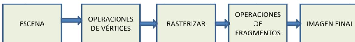
Figura 11: Esquema gráfico en la generación de imágenes sobre una GPU.
