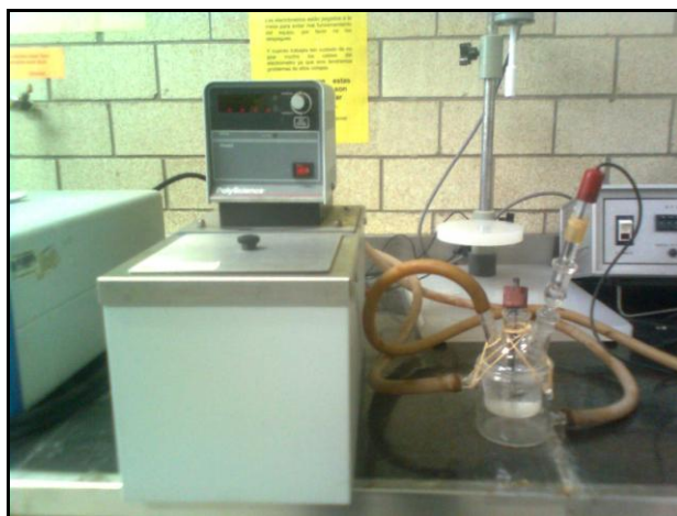
Figura 29. Baño isotérmico acoplado a la celda electroquímica.
