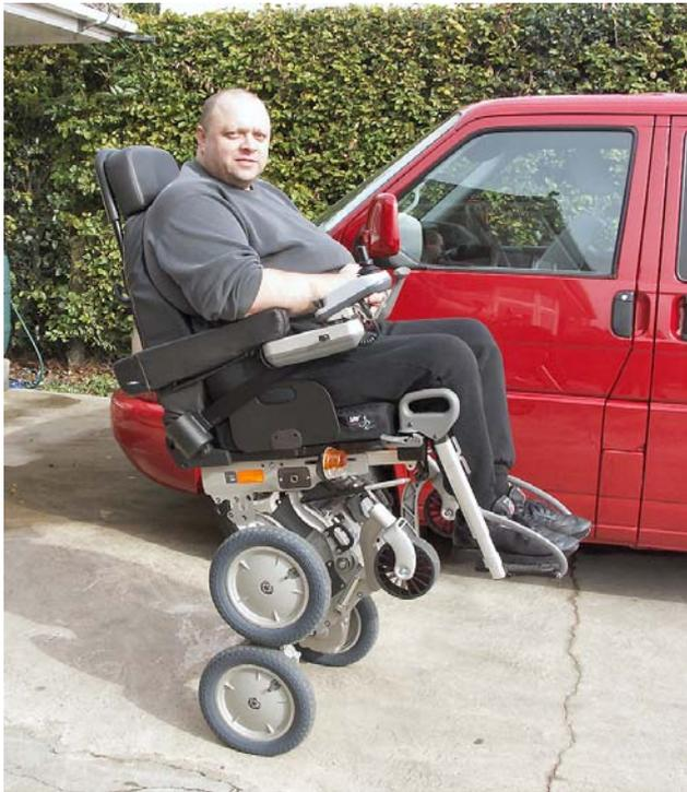
**Figura 1.23.** El inventor y su Silla iBOT balanceada sobre dos ruedas.
