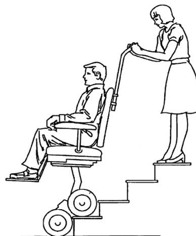
**Figura 3.10** Esquema de silla escaladora patentada 6799649 ascendiendo escalera.
