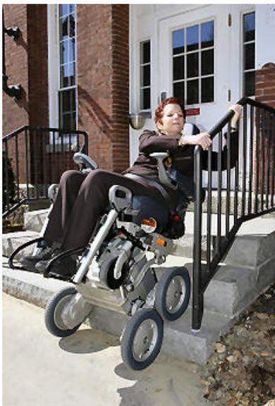
**Figura 1.24.** Sistema iBOT en operación de ascenso de escaleras.
