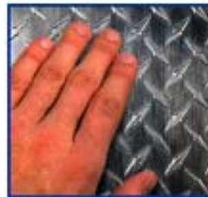
Fig. 3.2 Intercambio de calor entre la mano y (a) la madera con e = 0.047 Ws^{1/2}/cm^2k y (b) el Aluminio con e = 2.464 Ws^{1/2}/cm^2k
