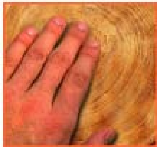
Fig. 3.2 Intercambio de calor entre la mano y (a) la madera con e = 0.047 Ws^{1/2}/cm^2k y (b) el Aluminio con e = 2.464 Ws^{1/2}/cm^2k
