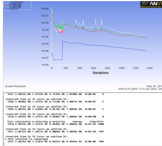
Figura 26.- Convergencia de resultados de simulación de transferencia de calor por convección natural en la placa vertical con aletas inclinadas a 45 grados.
