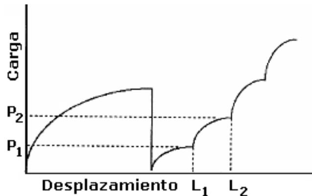
**Figura 13. Curva carga – alargamiento a una temperatura constante con cambios en la velocidad de deformación.**
