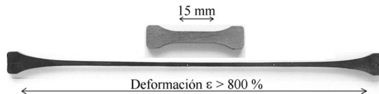
**Figura 1.** Ejemplo de la deformación superplástica de un acero ultra alto carbono X140 Cr2 Al7 ensayado a una  $T = 880 \text{ }^\circ\text{C}$  y una  $\dot{\epsilon} = 3 \times 10^{-3} \text{ s}^{-1}$ .
