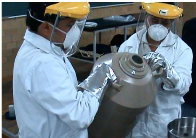
Fig. 4.3 Equipo y vestidura especial para el manejo de líquidos criogénicos.
