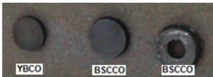
Fig. 4.5 Pastillas superconductoras
