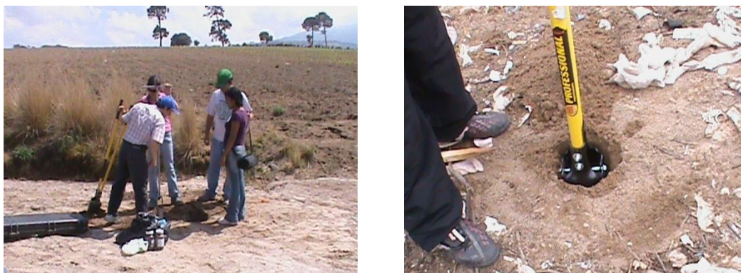
Figura 4.4. Extracción de muestras de suelo en Ayahualulco
