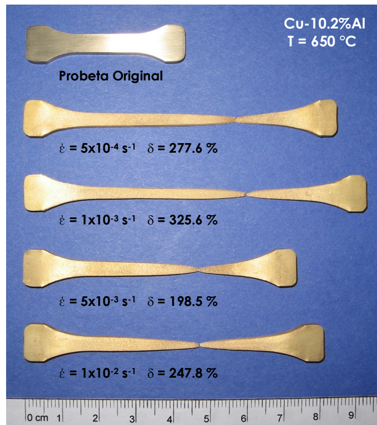
Figura 22. Elongaciones máximas de la aleación Cu-10.2%(peso)Al a 650 °C.
