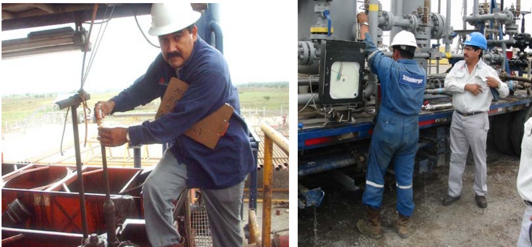
Fig. 1.3.a - Muestreo realizado en vacutainer o tubo al vacío y cilindro de acero o bala adaptado a las condiciones mecánicas del pozo
