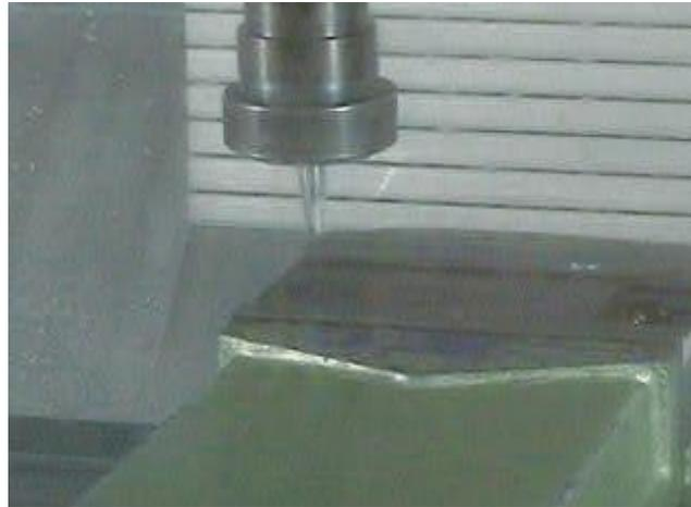
Esta imagen muestra el acercamiento del segundo cortador, para poder proporcionar la altura de dicho cortador.
