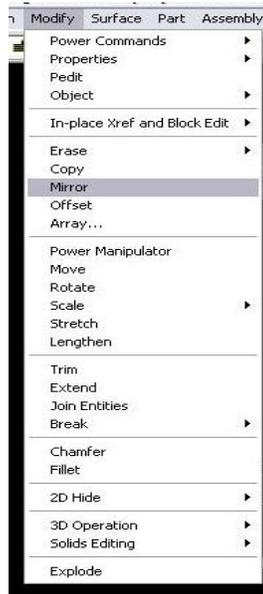
Desplegamos la ventana que se ve en la imagen y nos movemos con el ratón hasta seleccionar la función. Esta función requiere seleccionar las entidades que se van a reflejar, como si se utilizara un espejo, de ahí el nombre en inglés de mirror.
