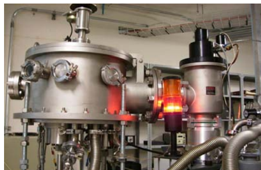
Figura 16. Reactor para depósitos de películas delgadas utilizando la técnica de Reactive Magnetron Sputtering.
