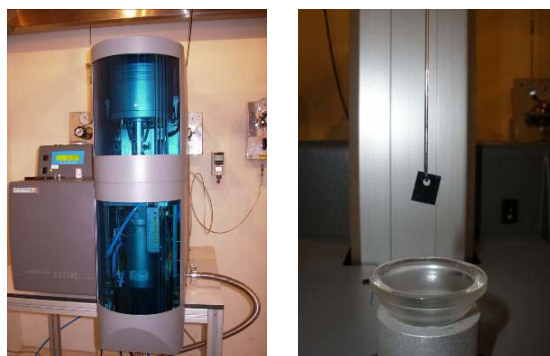
Figura 17. Termobalanza SETARAM Setsis Evolution y colocación de la muestra.
