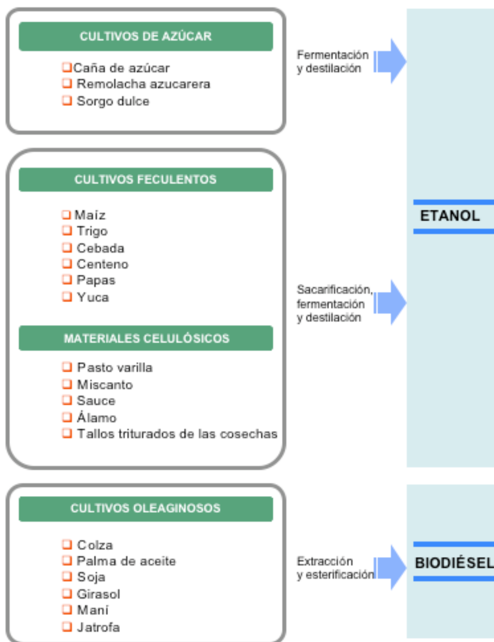
Figura 3. Conversión de materias primas agrícolas en biocombustibles líquidos. Fuente: FAO, 2008.
