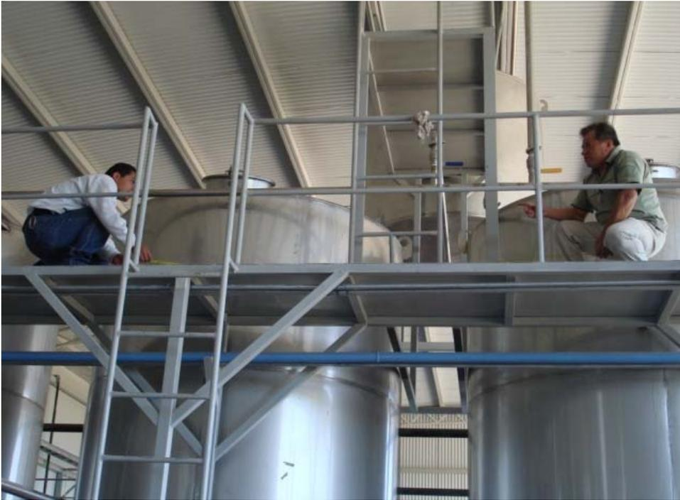
Figura 12. Destiladores de acero inoxidable de la planta procesadora de Nombre de Dios
