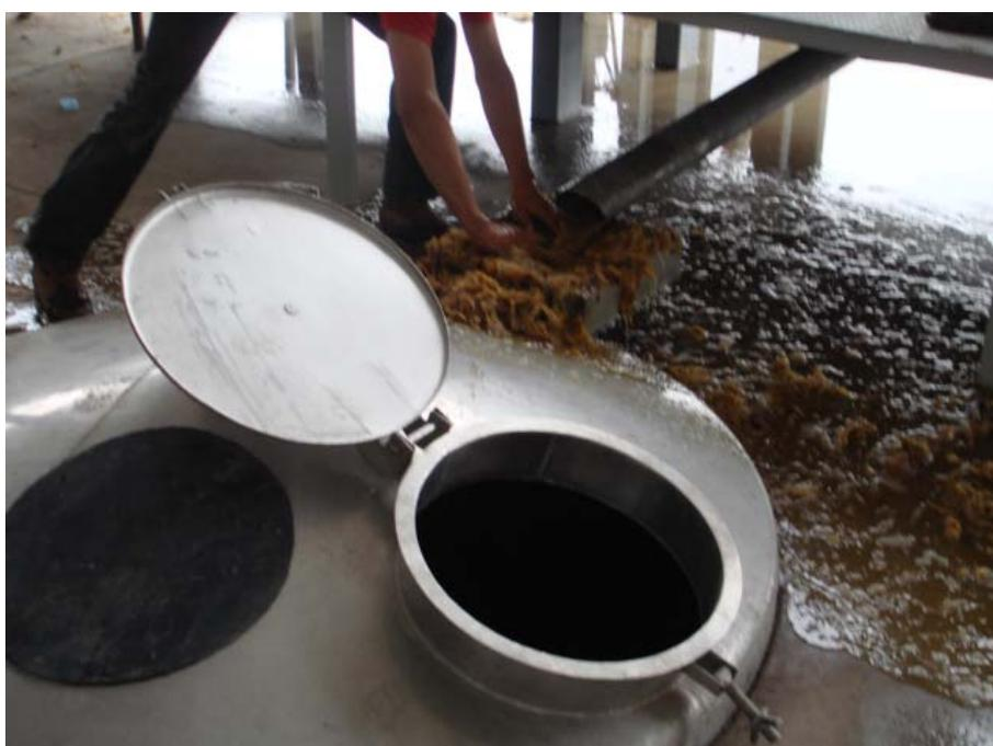
Figura 9. Tanque fermentador de acero inoxidable de la planta procesadora de Nombre de Dios (Fotografía: Vicente Hernández Vargas)
