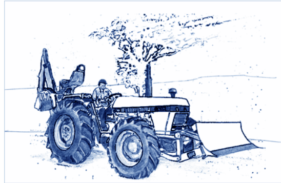
Figura 3. Tractor agrícola adaptado para las operaciones del relleno sanitario 7
