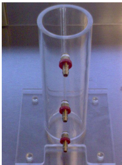
Figura 9. Columna de acrílico, diseñada para realizar lavados in situ .
