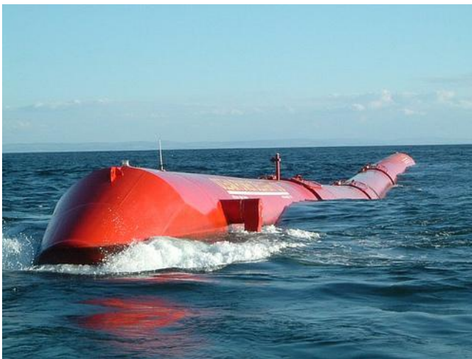
Fig. 22 Sistema generador de energía undimotriz.
