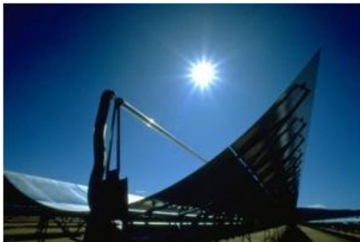
Fig. 11 Sistemas solares térmicos de concentración o enfoque. Fuente: FGRT11
