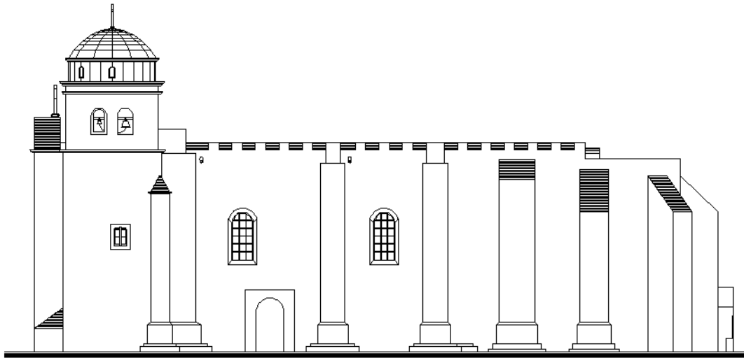
Figura 2.9. Fachada sur del templo. Se aprecian principalmente contrafuertes y almenas propias del estilo en estas edificaciones.
