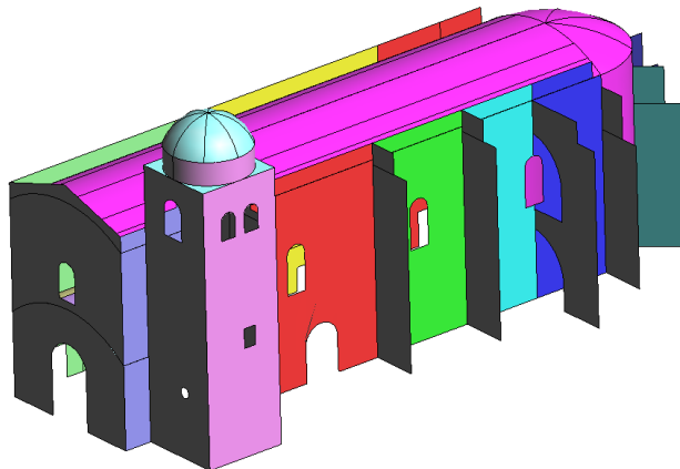
Figura 3.5. Generación de superficies. Cada color simboliza el diferente grupo físico que poseerá sus propias características geométricas y mecánicas.
