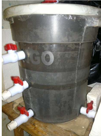
Figura 6.1.2.1, Reactor anaerobio usado para la depuración de las aguas residuales del Río Chico los Remedios. Fuente: Elaboración propia.
