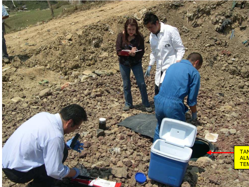
Figura 3.1.2.3 Toma de muestra de lixiviados y medición de los parámetros de campo, en el Relleno Sanitario en Rincón Verde, realizados el 26 de mayo del 2006. Fuente: Elaboración propia
