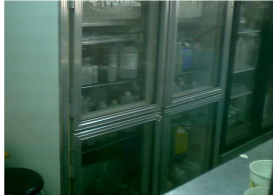
Fig. 4.20. Refrigeración de las muestras con registro de temperatura automatizada durante las 24 horas. Cortesía del Laboratorio de Análisis y Tratamiento de Aguas UAM-Azcapotzalco Fuente: Elaboración propia.
