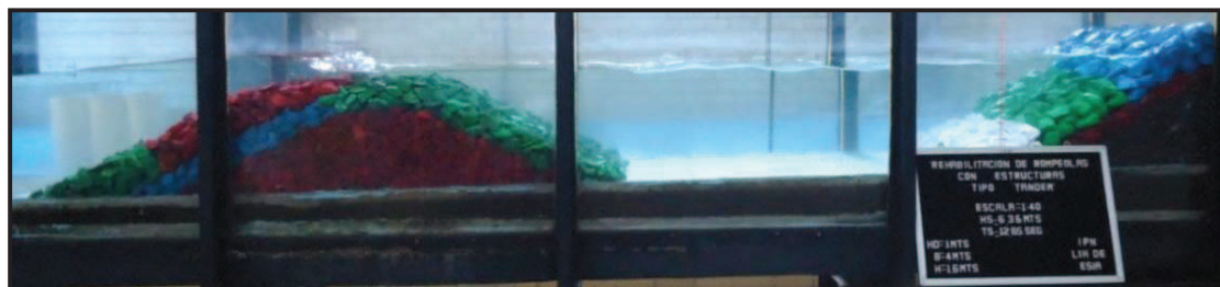
Figura IV.23. Ensayo 4: Para H= 6.36\text{m} y T= 12.65\text{s}
