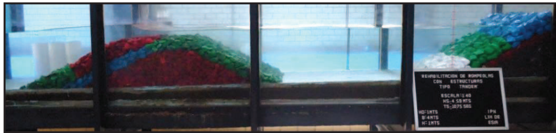
Figura IV.26. Ensayo 1: Para H= 4.59\text{m} y T= 10.75\text{s}
