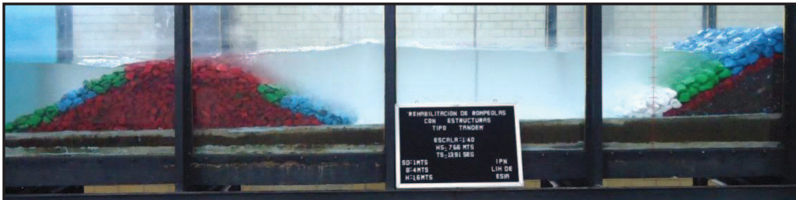
Figura IV.49. Ensayo 6: Para H= 7.66m y T= 13.91s
