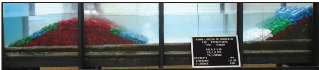
Figura IV.51. Ensayo 2: Para H= 5.13\text{m} y T= 11.38\text{s}
