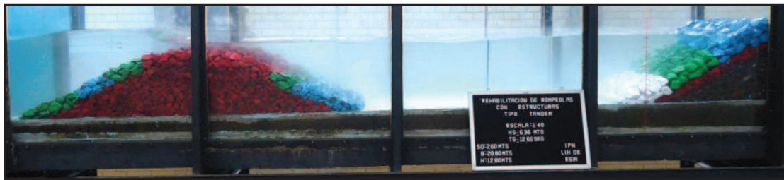
Figura IV.54. Ensayo 4: Para H= 6.36\text{m} y T= 12.65\text{s}
