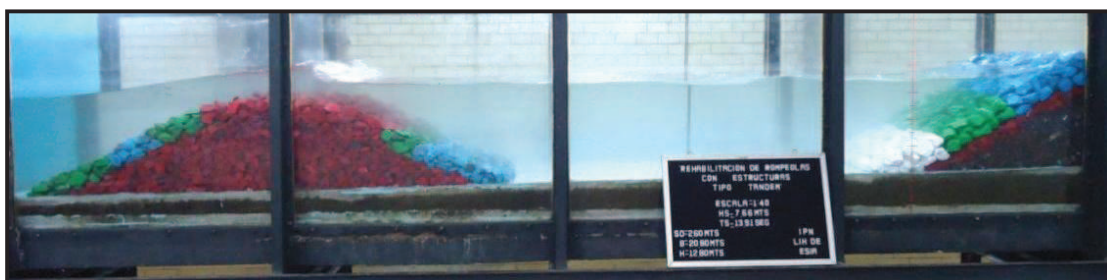
Figura IV.56. Ensayo 6: Para H= 7.66\text{m} y T= 13.91\text{s}
