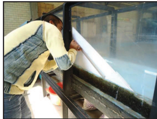
Figura IV.11. Trazo del escantillón (A) y trazo en la pared de acrílico para el rompeolas superficial (B)
