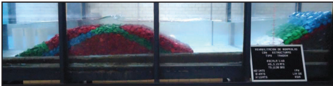
Figura IV.39. Ensayo 2: Para H= 5.13\text{m} y T= 11.38\text{s}
