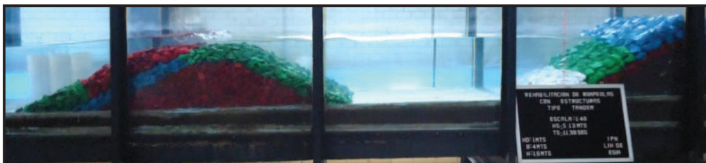
Figura IV.21. Ensayo 2: Para H = 5.13\text{m} y T = 11.38\text{s}
