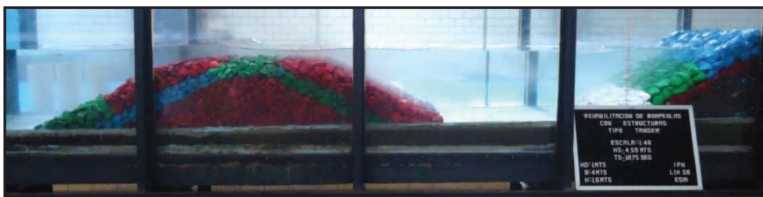
Figura IV.38. Ensayo 1: Para H = 4.59\text{m} y T = 10.75\text{s}
