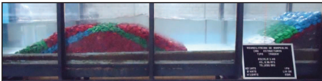
Figura IV.41. Ensayo 4: Para H= 6.36\text{m} y T= 12.65\text{s}
