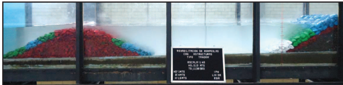
Figura IV.45. Ensayo 2: Para H= 5.13\text{m} y T= 11.38\text{s}
