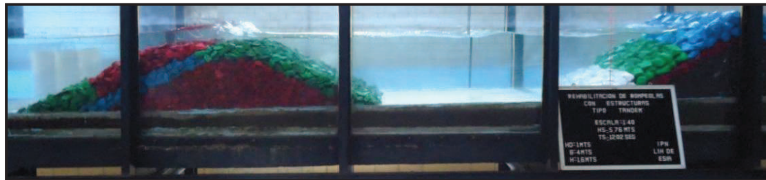
Figura IV.22. Ensayo 3: Para H= 5.76\text{m} y T= 12.02\text{s}
