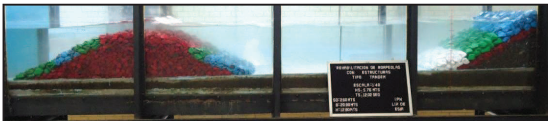
Figura IV.52. Ensayo 3: Para H= 5.76\text{m} y T= 12.02\text{s}
