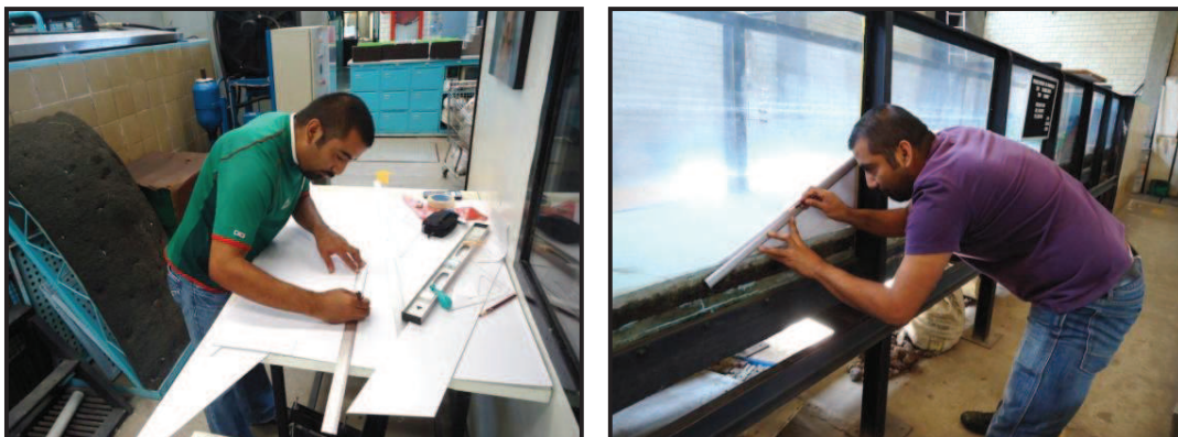
Figura IV.17. Trazo del escantillón para los rompeolas sumergido y trazo en pared de acrílico.
