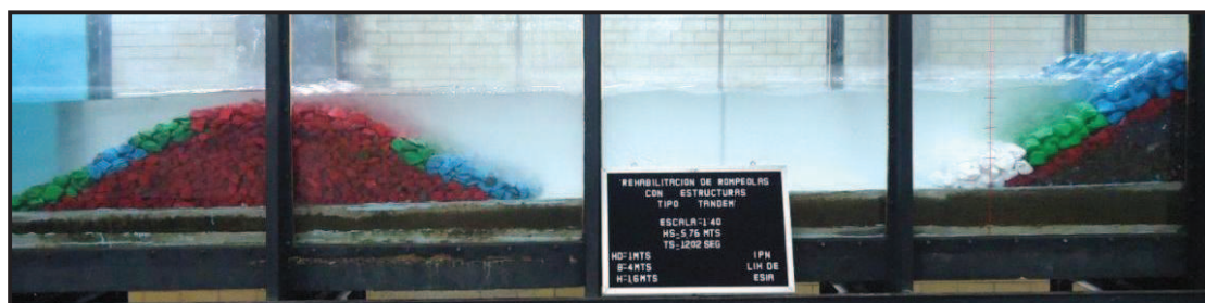
Figura IV.46. Ensayo 3: Para H= 5.76\text{m} y T= 12.02\text{s}
