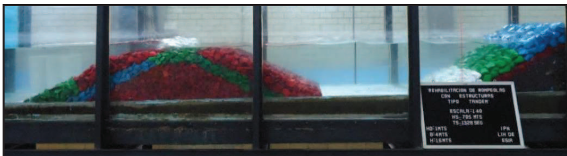
Figura IV.43. Ensayo 6: Para H= 7.66\text{m} y T= 13.91\text{s}
