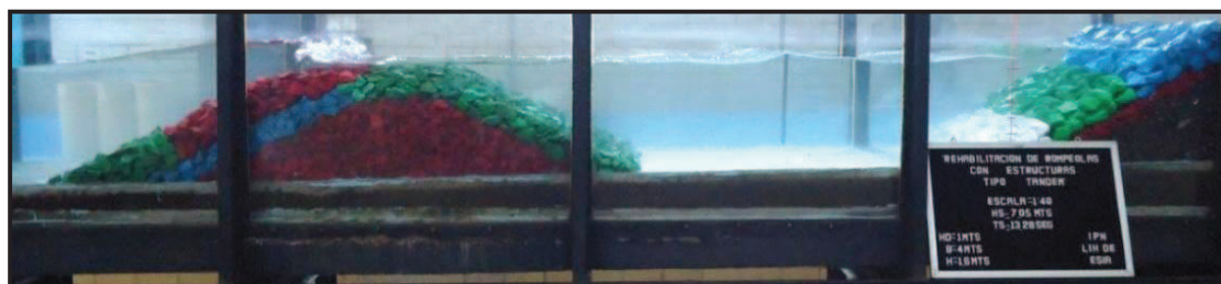
Figura IV.24. Ensayo 5: Para H= 7.05\text{m} y T= 13.28\text{s}
