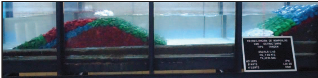
Figura IV.25. Ensayo 6: Para H= 7.66\text{m} y T= 13.91\text{s}
