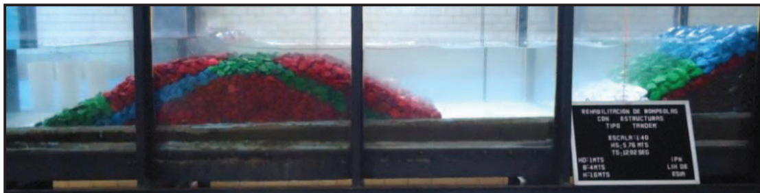
Figura IV.40. Ensayo 3: Para H= 5.76\text{m} y T= 12.02\text{s}
