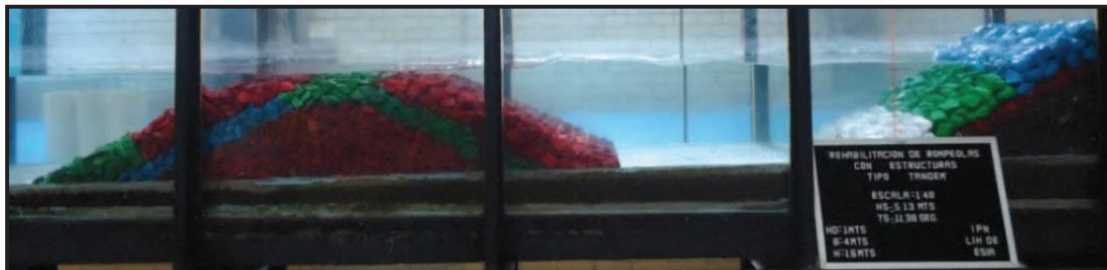
Figura IV.33. Ensayo 2: Para H= 5.13\text{m} y T= 11.38\text{s}
