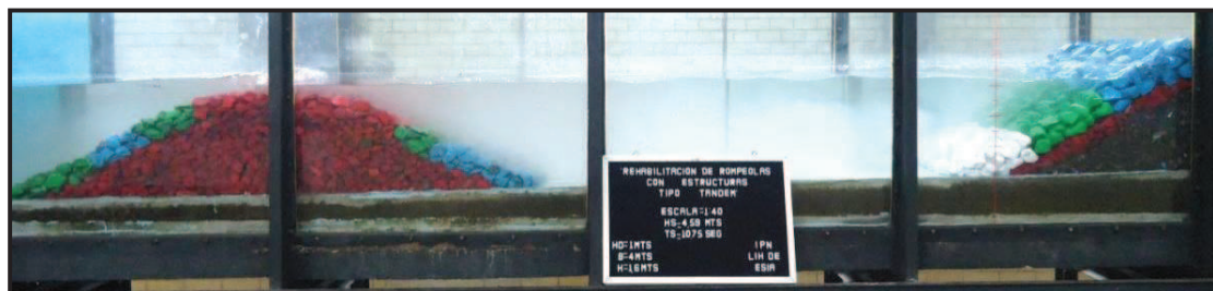
Figura IV.44. Ensayo 1: Para H = 4.59\text{m} y T = 10.75\text{s}
