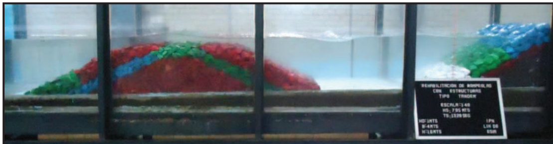
Figura IV.42. Ensayo 5: Para H= 7.05\text{m} y T= 13.28\text{s}
