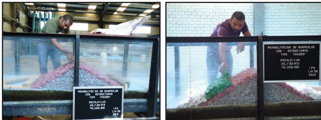
Figura IV.13. Colocación de capa secundaria y coraza del rompeolas superficial
