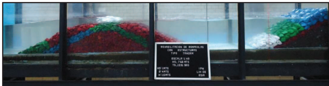
Figura IV.37. Ensayo 6: Para H= 7.66\text{m} y T= 13.91\text{s}
