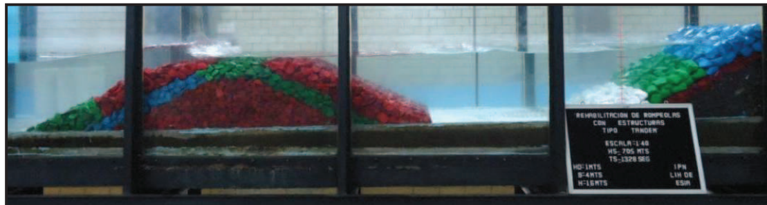
Figura IV.36. Ensayo 5: Para H= 7.05\text{m} y T= 13.28\text{s}
