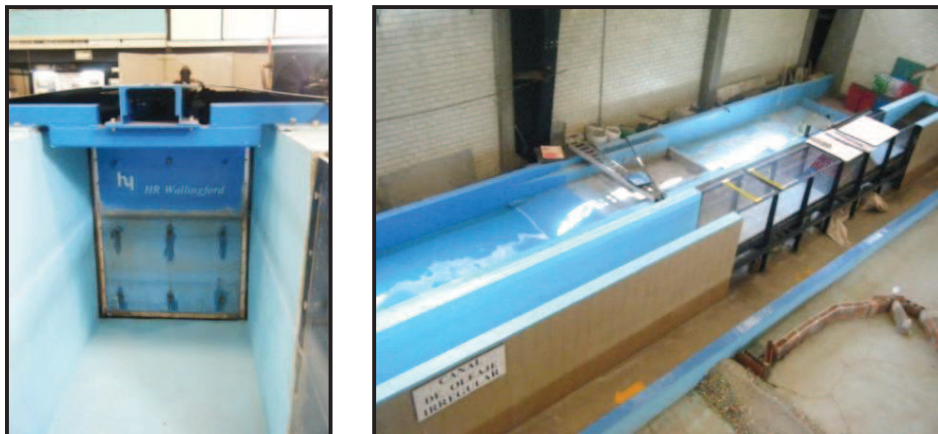
Figura IV.4. Paleta generadora de oleaje (izq.) y canal angosto en su zona de observación (der.)
