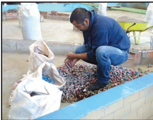
Figura IV.8. Selección de roca de núcleo y capa secundaria (izq.) y rehabilitación de roca de coraza para la franja verde (der.)
