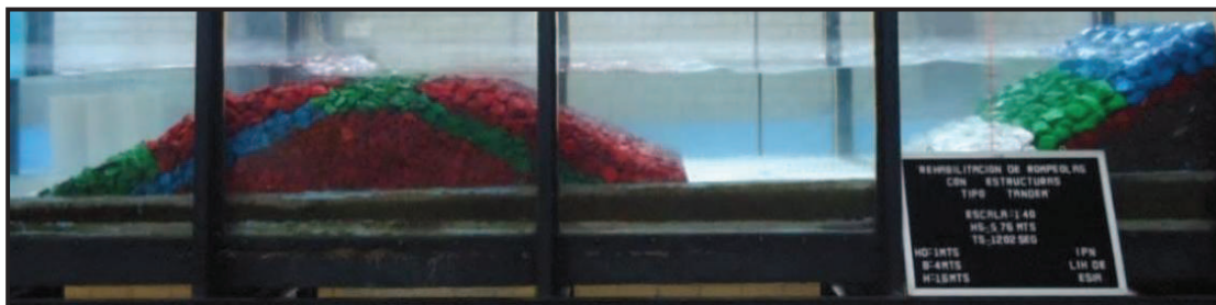
Figura IV.34. Ensayo 3: Para H= 5.76\text{m} y T= 12.02\text{s}
