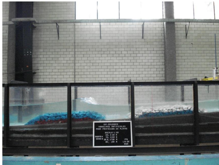
Fig. 5.29. Estructuras (2) de 17 m de ancho de coronamiento, con 7 m de separación, sumergencia 1.00 m.
