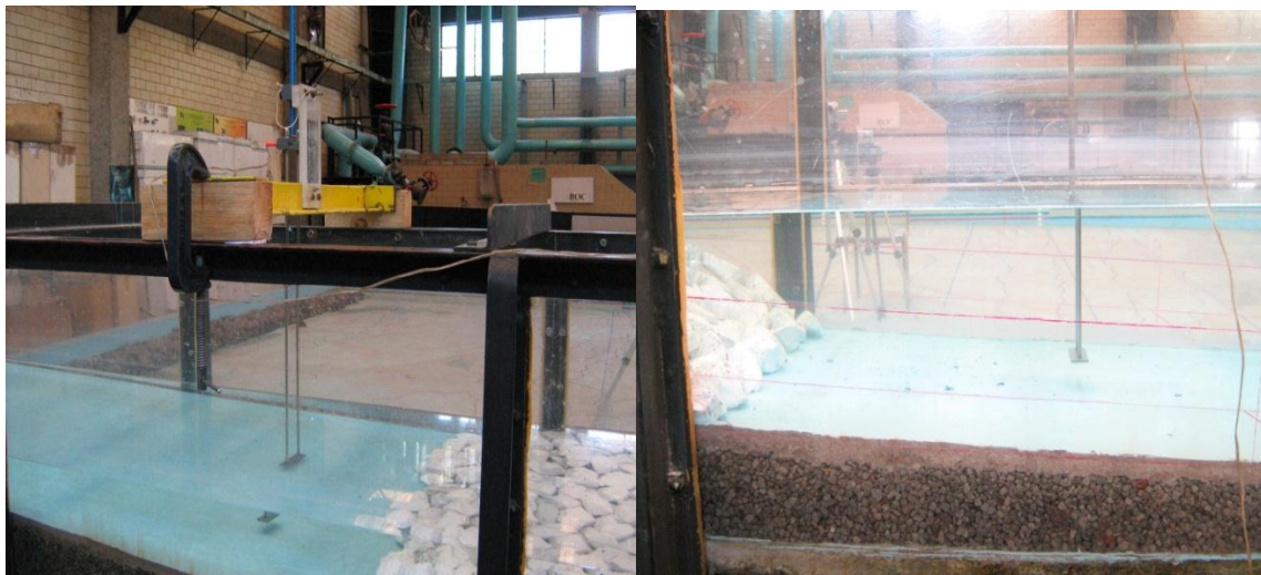
Fig. 5.14. Calibración de los sensores en aguas someras y aguas intermedias
