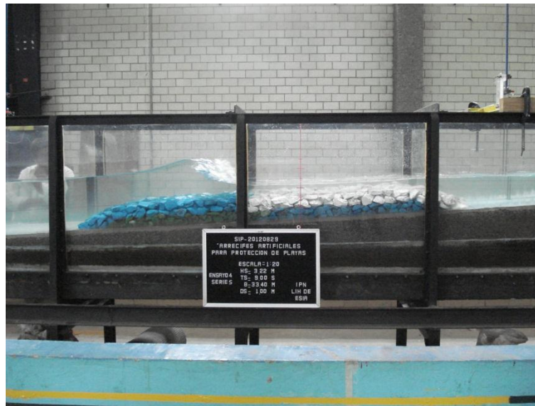
Fig. 5.21. Ancho de coronamiento de 34 m. sumergencia 1.00 m.
