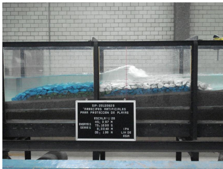
Fig. 5.22. Disminución de la energía de la ola sobre un ancho de coronamiento de 34 m, sumergencia 1.00 m.
