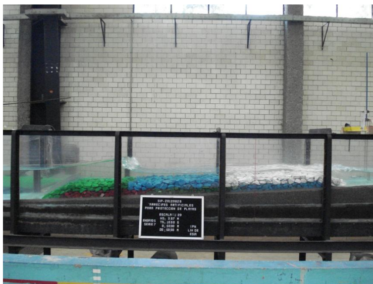
Fig. 5.24. Rompiente parcial sobre un ancho de coronamiento de 50 m, sumergencia 0.50 m.
