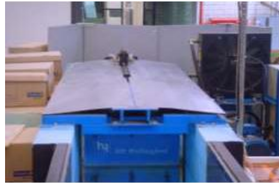
Fig. 5.3. Vista de la paleta y el generador de oleaje.
