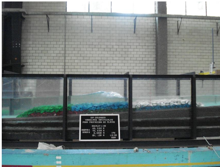
Fig. 5.25. Fricción entre la ola y el arrecife de 50 m de ancho de coronamiento. sumergencia 1.00 m.
