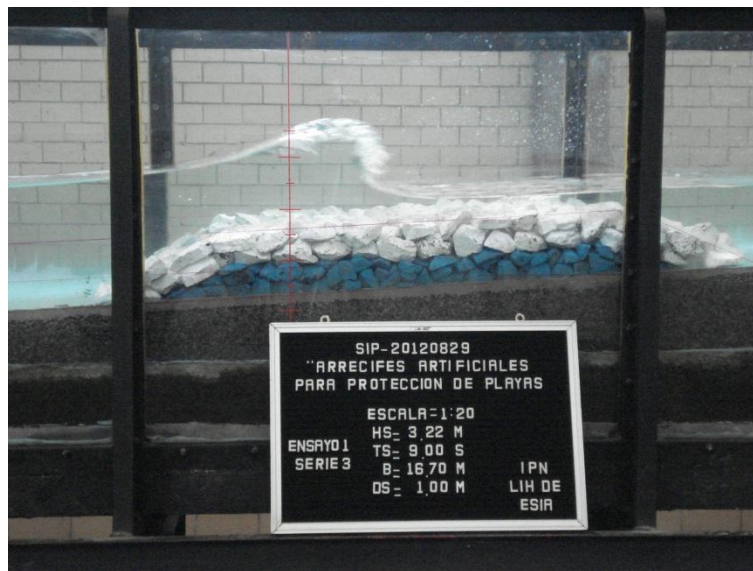
Fig. 5.17. Rompiente total sobre la parte media del ancho de coronamiento de 17 m, sumergencia 1.00 m.
