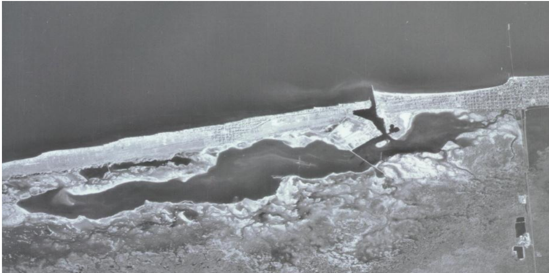
Fig. 2.10. Fotografía de 1979 en donde se encuentran las escolleras del Puerto de Abrigo de Yucalpetén, el cual se inauguró en 1968. Se observa una zona urbana en expansión con casas veraniegas sobre la playa y una fuerte disminución de áreas verdes y rellenos en ciénagas modificando la línea de playa y promoviendo la erosión en el sitio. Hay una fuerte ganancia de arena en la porción occidental (Yucalpetén) con 300 metros de ancho, con respecto a la línea de playa de 1948 [Pérez, 1977].
