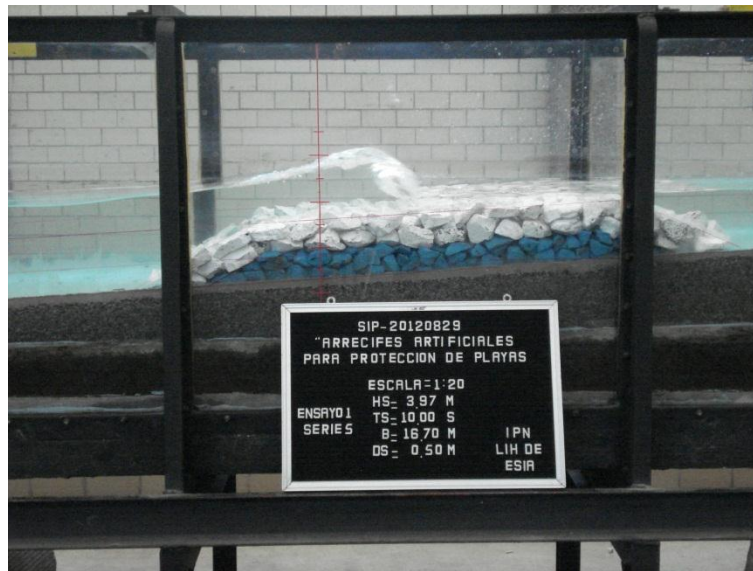
Fig. 5.16. Rompiente total sobre la mitad del ancho de coronamiento de 17 m, sumergencia 0.50 m.
