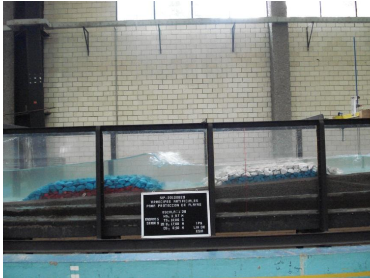
Fig. 5.28. Rompiente total sobre el espaciamiento de las estructuras.
