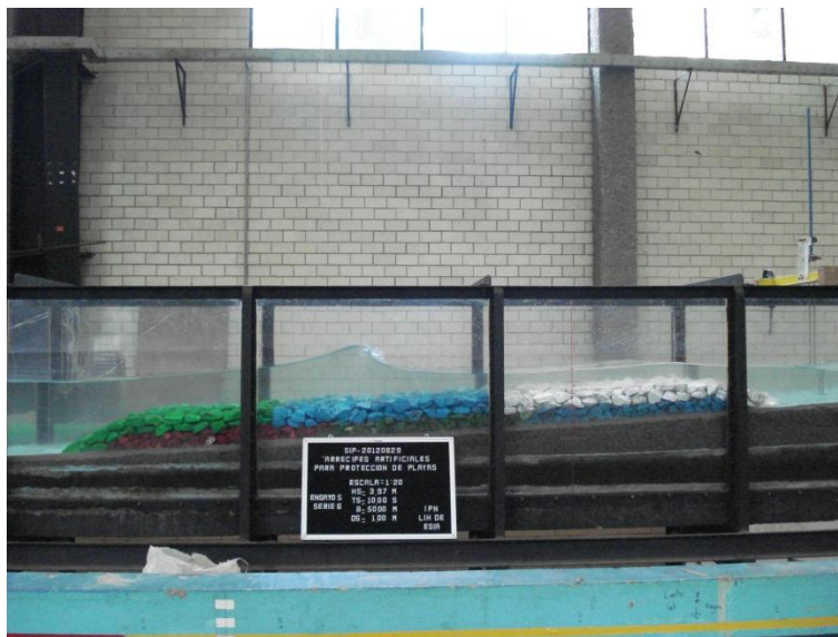
Fig. 5.26. Inicio de la formación de una rompiente total sobre un ancho de coronamiento de 50 m, sumergencia 1.00 m.
