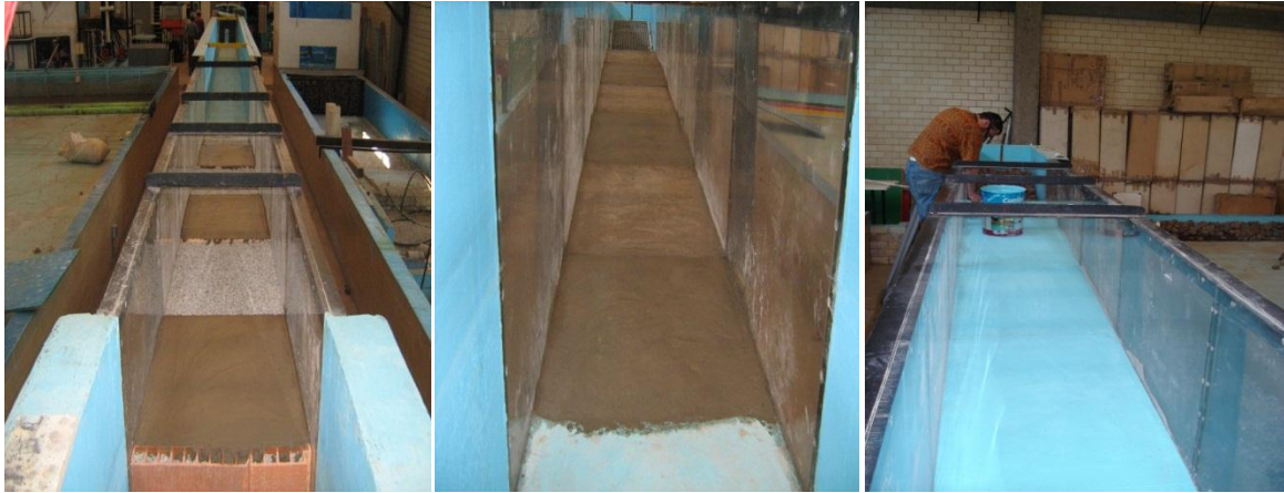
Fig.5.11. Colado y tratamiento del firme.
