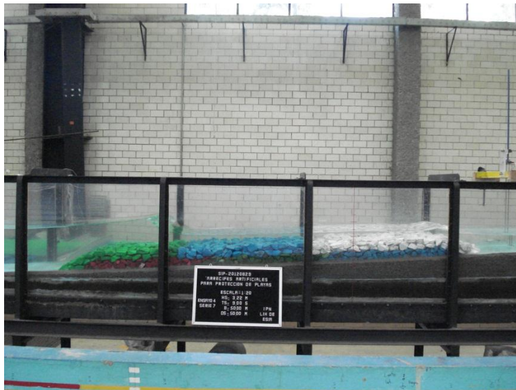
Fig. 5.23. Ancho de coronamiento de 50 m. sumergencia 0.50 m.
