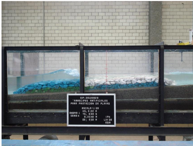
Fig. 5.19. Rompiente total sobre un ancho de coronamiento de 34 m, sumergencia 0.50 m.
