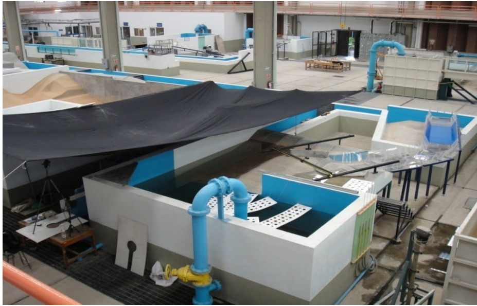
FIGURA 52. Modelo de la presa “Veladero de Camotlán” ubicado dentro de las instalaciones del IMTALAB.
