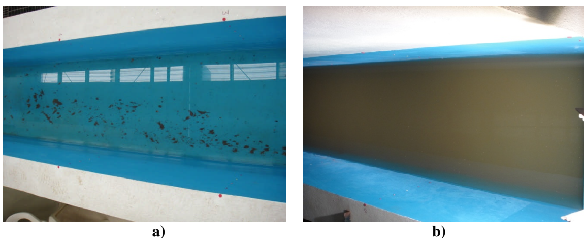
FIGURA 54. a) Fondo del canal antes de colocar el lecho de tierra; b) Fondo de canal con lecho de tierra con el fin de uniformizar la forma del mismo.
