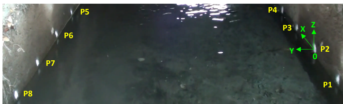
FIGURA 51. Imagen instantánea del área de estudio y puntos de control marcados para el cálculo de la geometría y rectificación de la imagen
