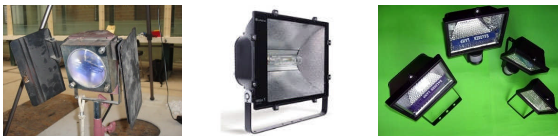
FIGURA 7. Algunos Modelos de lámparas de halógeno utilizadas para la iluminación en la técnica de LSPIV de laboratorio.
