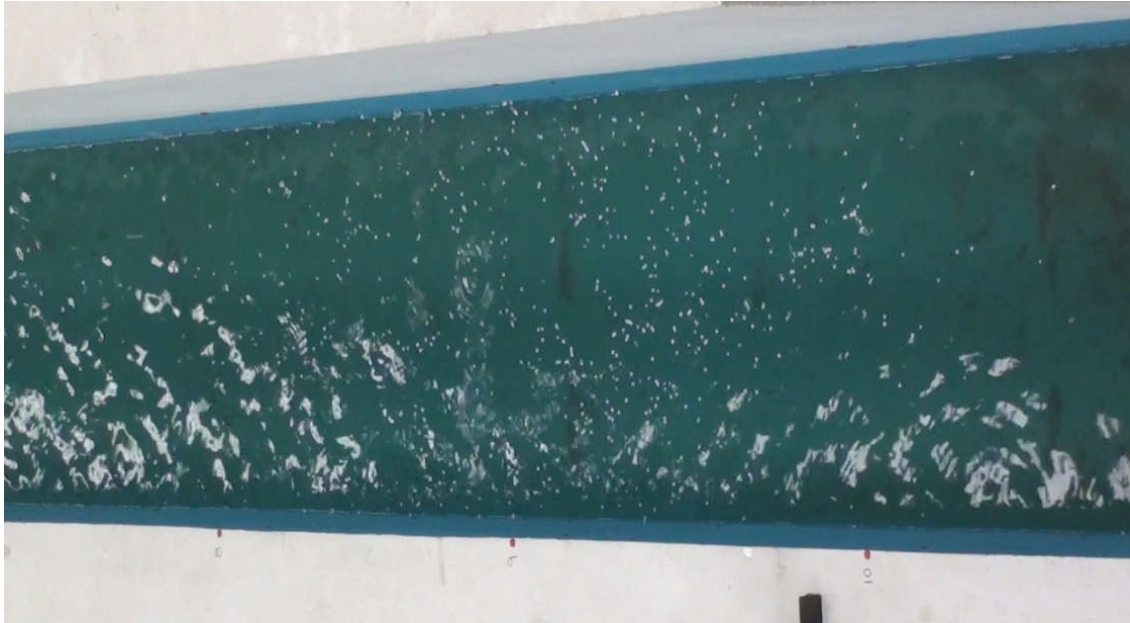
FIGURA 74. Imagen del canal sin modificaciones para ser procesada en la cual se observan reflejos estáticos sobre la superficie.
