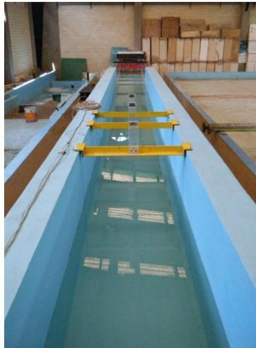
Figura 15. Canal de oleaje del Laboratorio de Ingeniería Hidráulica (LIH).
