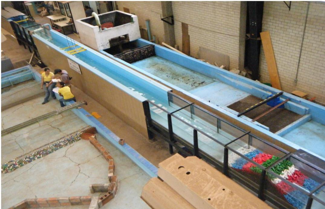
Figura 33. Arreglo de la estructura y los sensores en el canal de oleaje.
