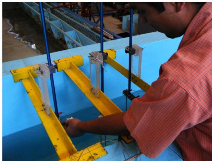
Figura 35. Disposición de sensores de oleaje en el canal angosto.
