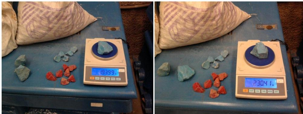
Figura 26. Pesaje de rocas manejadas en el modelo de rompeolas clásico de roca de 12 ton promedio.
