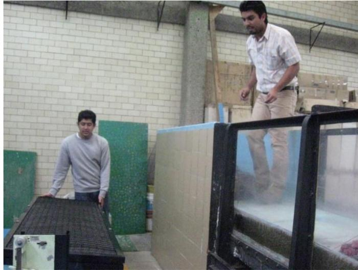
Figura 23. Colocación del amortiguador en el final del canal angosto de oleaje.
