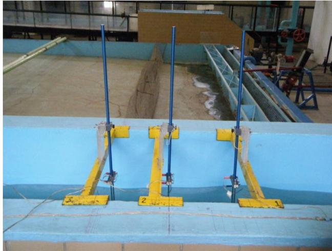
Figura 34. Sensores de oleaje.
