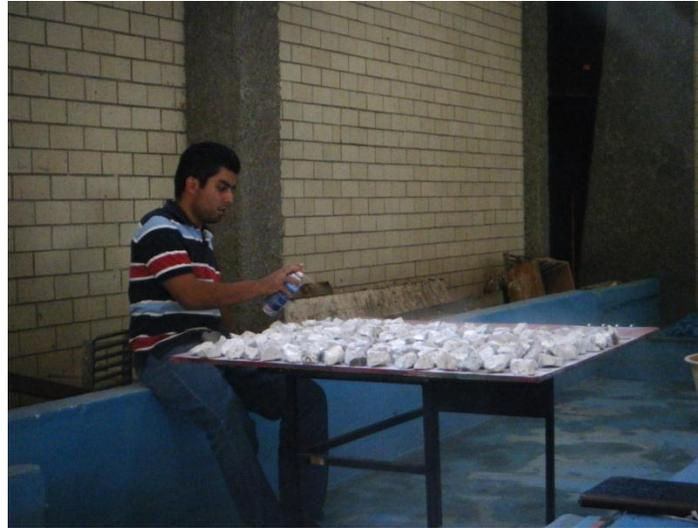
Figura 28. Preparación del material pétreo, aplicación de pintura.
