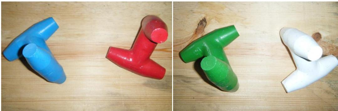
Figura 29. Dolos utilizados en el modelo de un rompeolas de tres capas con coraza de elementos prefabricados, con un peso de 19 ton en prototipo.
