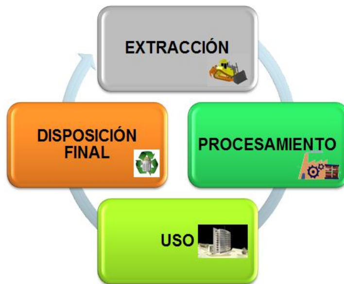
Figura No. 2.2 Ciclo de vida de materiales de construcción. Fuente: BREEAM (BRE Environmental Assessment Method, 2009).
