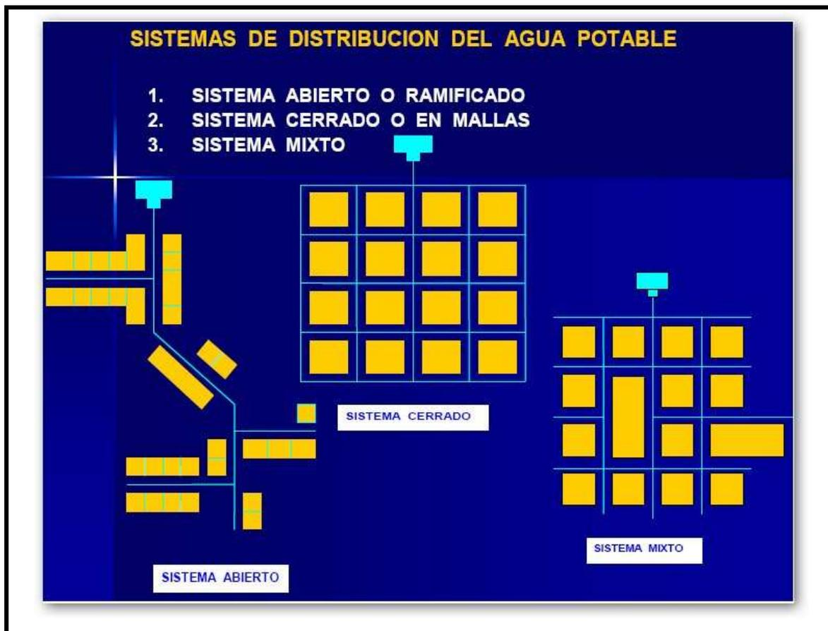
Figura 2.17 Sistemas de distribución de agua potable
