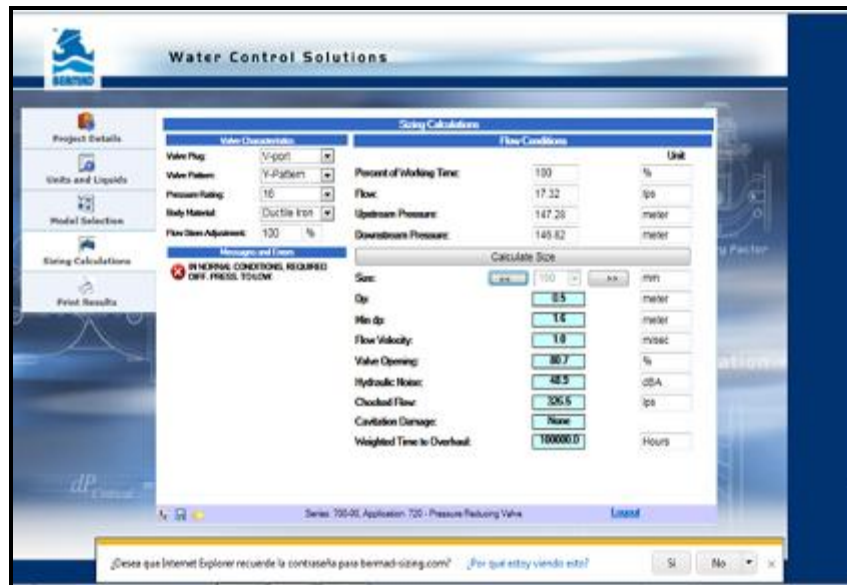
Figura 3. 36. Datos hidráulicos para la selección de la VRP No.851 para gasto mínimo.
