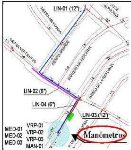
Figura 3. 14. Punto de Abastecimiento Manómetros
