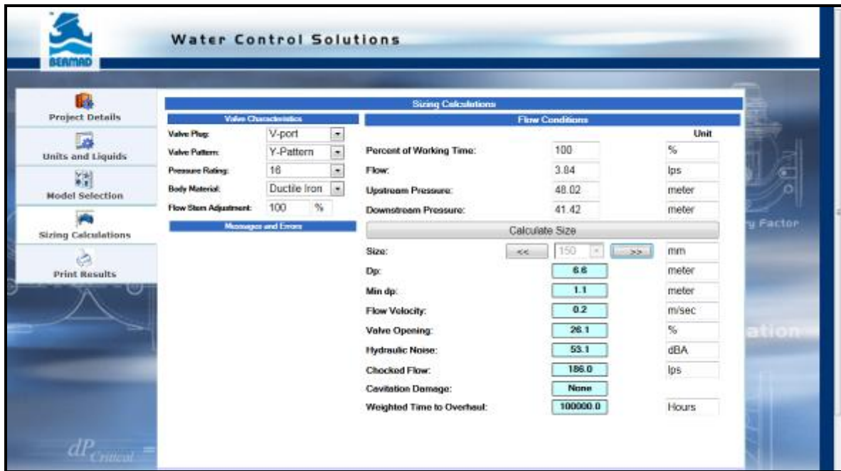
Figura 3. 42. Datos hidráulicos para la selección de la VRP No.386 para gasto mínimo.
