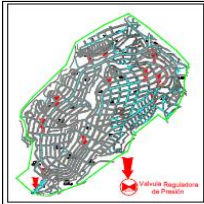
Figura 4. 8. Distribución de Válvulas Reguladoras de Presión.
