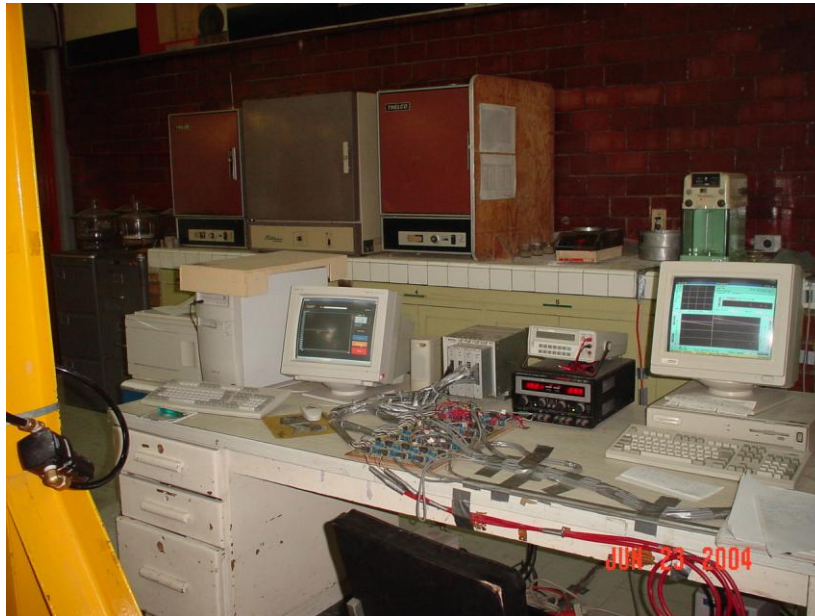
Fig. 3.23 Monitoreo de los sensores durante ejecución de ensayo estático A2
