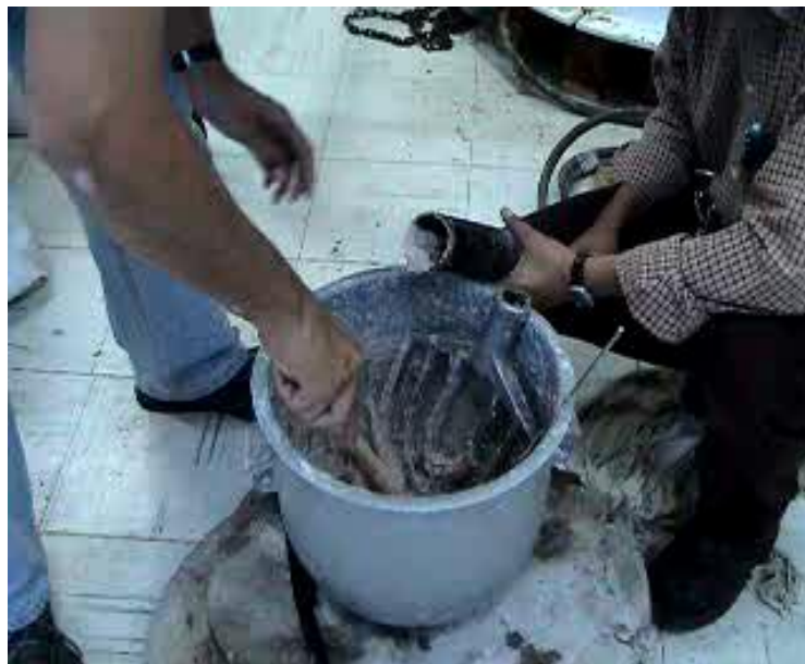
Fig. 3.21 Llenado de la mezcla en la engrasadora
