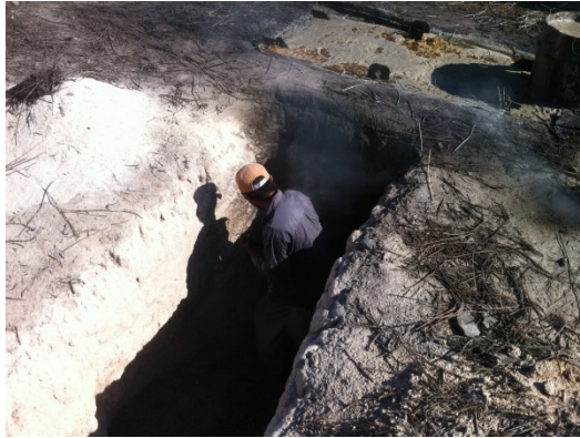
Imagen Núm. 17 Alimentado del horno bajo la paila con candelilla seca de desecho
