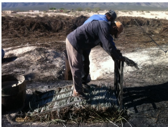
Imagen Núm. 19 Cerrado de la prensa de hierro para comenzar a hervir la planta de candelilla
