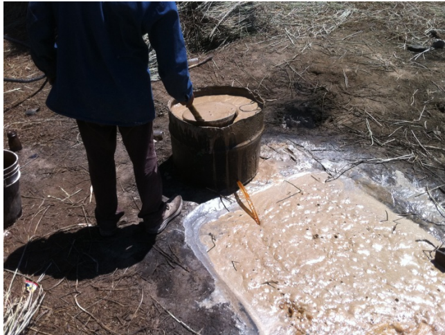
Imagen Núm. 22 Drenado de solución residual de la cera en proceso de solidificación y su reincorporación a la paila
