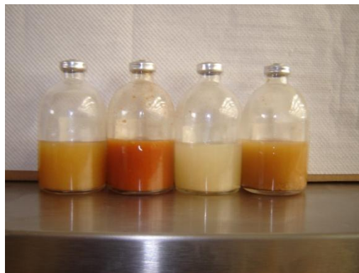
Figura 5. De izquierda a derecha se muestran los microcosmos en donde se usó como sustrato: piña, sandía, ácido acético y limón.
