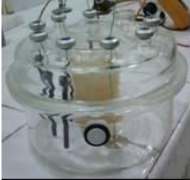
Figura 20. CCM montada antes de entrar en operación.
