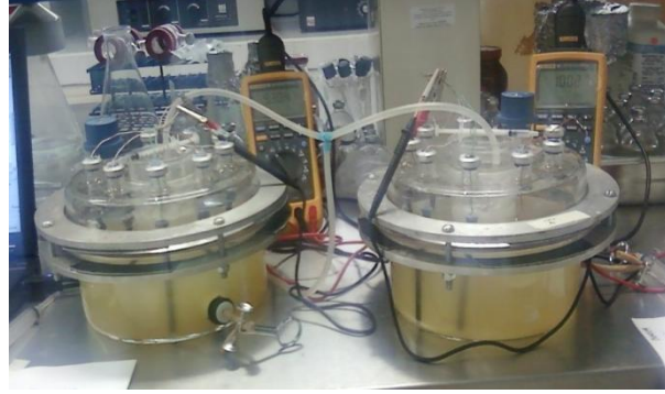
Figura 21. CCMs en operación, a la izquierda la celda que opera con los lixiviados del reactor 1, a la derecha la celda en funcionamiento con los lixiviados del reactor 2.
