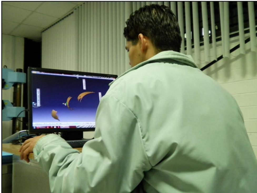
Ensamble de las nubes de puntos pertenecientes a un caso de deformación de copa, obtenidas mediante el equipo de correlación de imágenes (diciembre de 2011).
