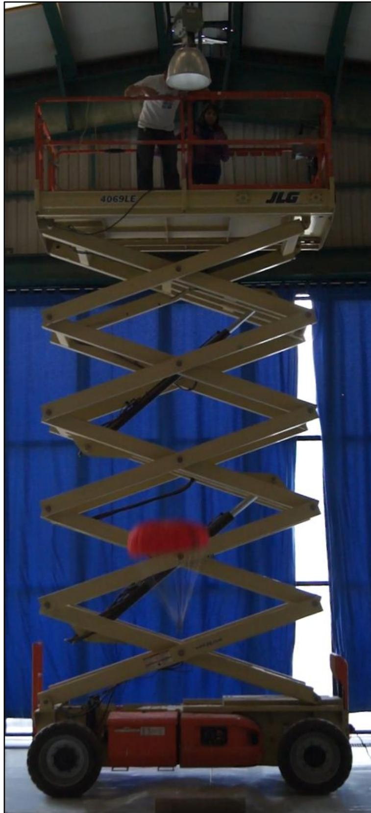
Lanzamiento del modelo desde una plataforma elevadora hidráulica durante pruebas experimentales de descenso libre (abril de 2012).
