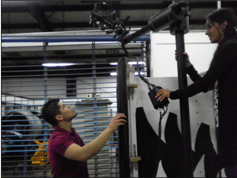
Ubicación preliminar de las cámaras del sistema de correlación de imágenes para obtener la geometría del gajo del paracaídas durante prueba de túnel de viento (julio de 2011).
