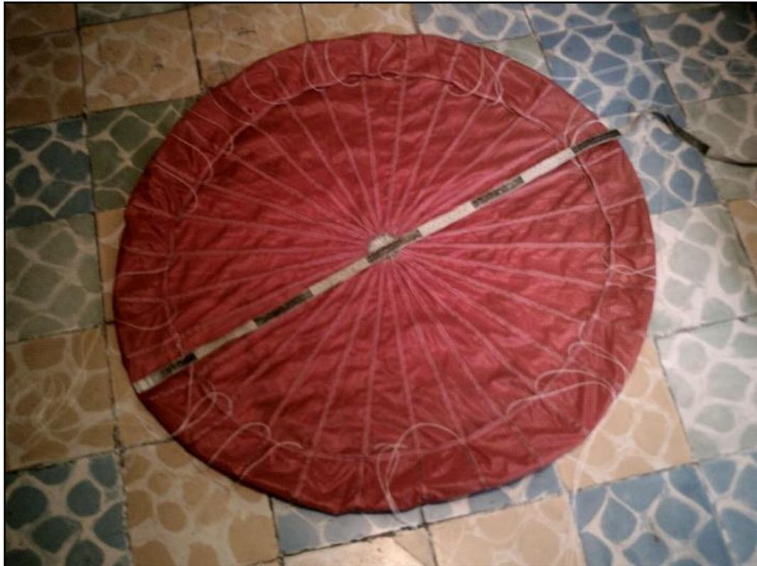
Imagen 3. Modelo a escala 2:21 del paracaídas T-10C.
