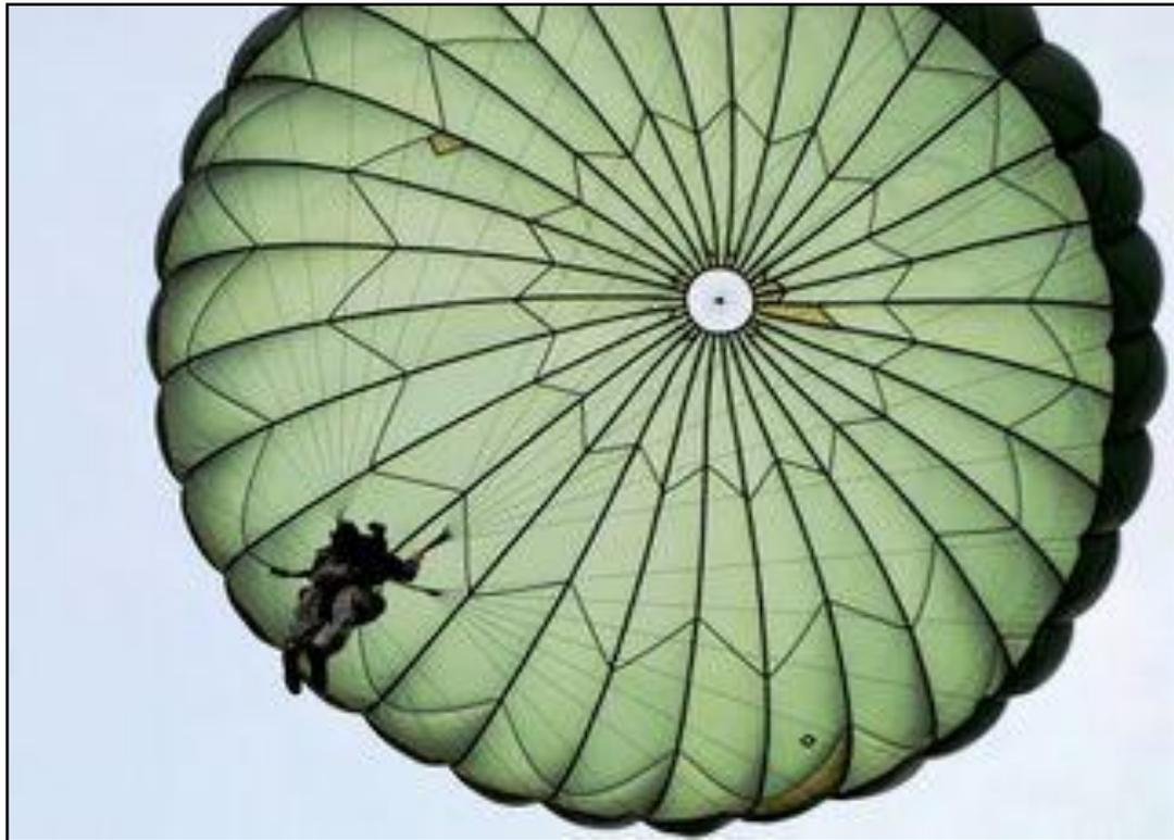
Imagen 1. Paracaídas de Falda Plana Extendida T-10 (textil sólido).
