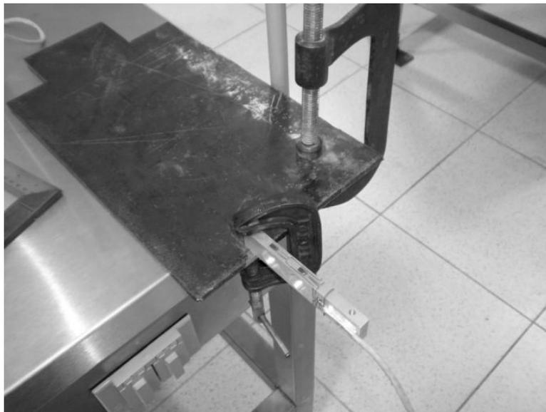
La terminal del transductor debe conectarse al sistema de adquisición de datos (System 7000) y este a su vez al ordenador con el software adecuado para interpretar y convertir las señales de forma apropiada.
