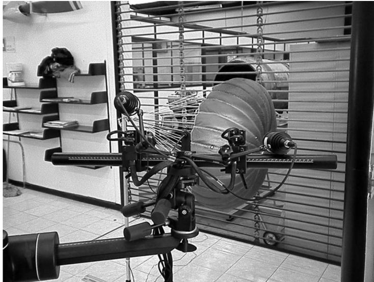
Получение геометрии части купола с системой цифровой корреляции изображения в тесте в аэродинамической трубе.
