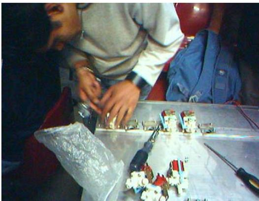
Figura 15.- Conexión física de las electro válvulas.
