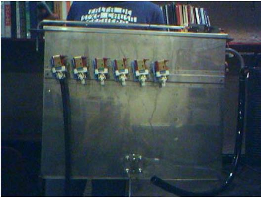
Figura 13.-Contenedor calentador de agua con electroválvulas.
