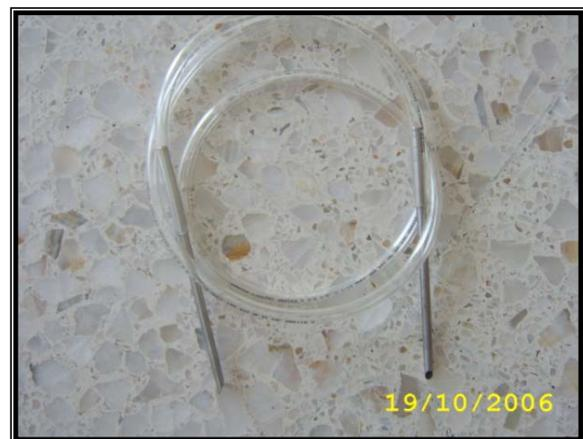
Figura 20.- Aguja de perforación ensamblada con la manguera de llenado.
