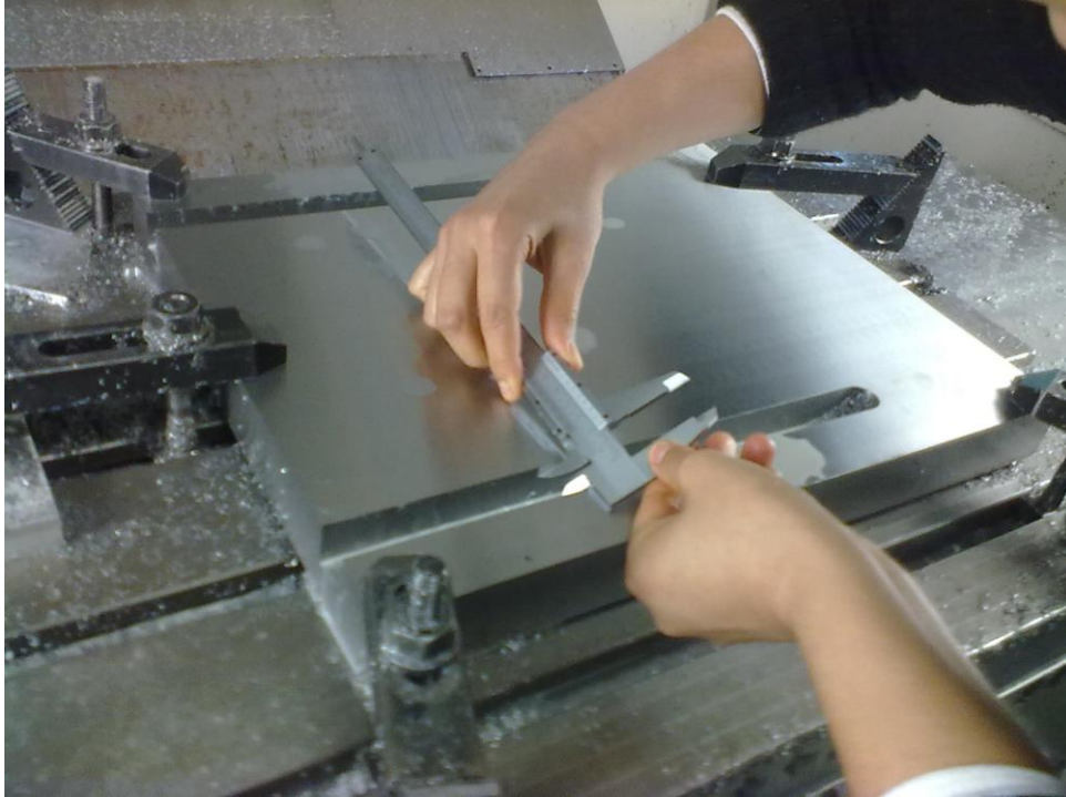
Figura 5.0.63 Verificación de la operación 10 (Ranurado) de la lista de inspección 1 con el instrumento Vernier
