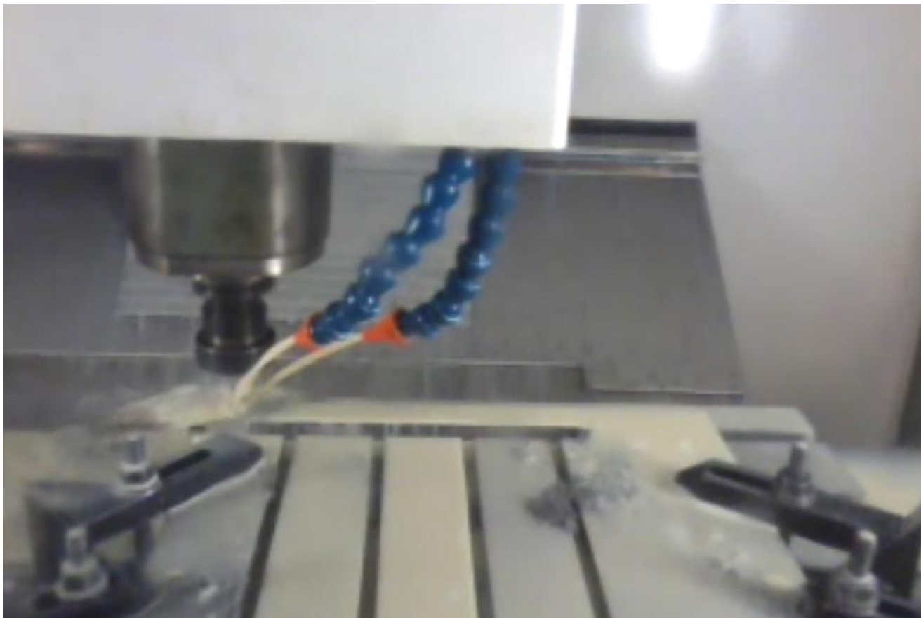
Figura 5.0.55 Operación de barrenado y diferente posicionamiento de bridas, esto para evitar daños a la herramienta, al holder o los sistemas de sujecion.
