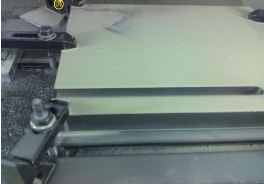
Figura 5.0.52 Inicio de la ranura entrando en vacío para evitar un procesos rampeado ya reducir el tiempo de maquinado
