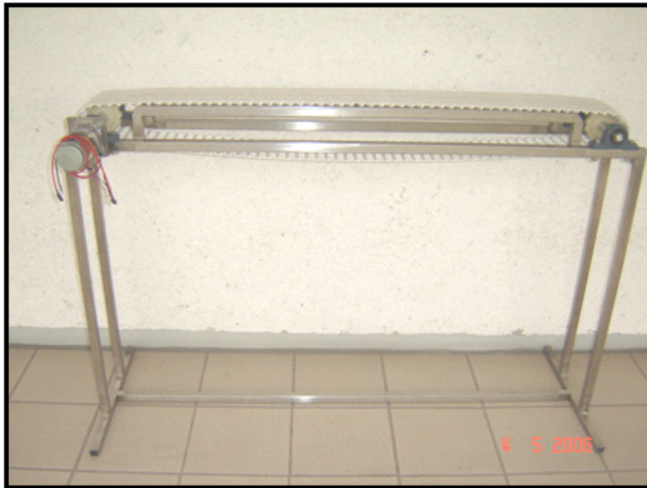
Figura 15. Mecanismo dosificador de paletas de hielo.
