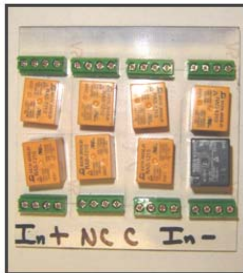
Figura 31. Etapa de potencia
