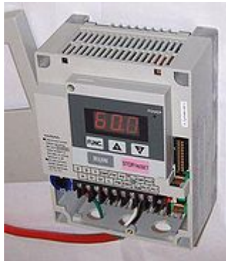
Pequeño dispositivo variador de frecuencia (VFD)
