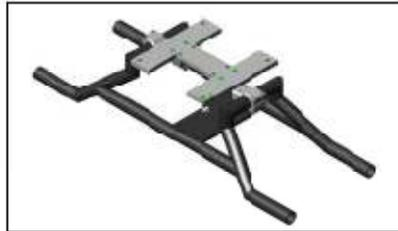
Fig. 3. Estructura tubular y plataforma móvil.
