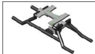
Fig. 6. Sistema mecánico para aumentar el ángulo de visión vertical del LIDAR HDL-64E.
