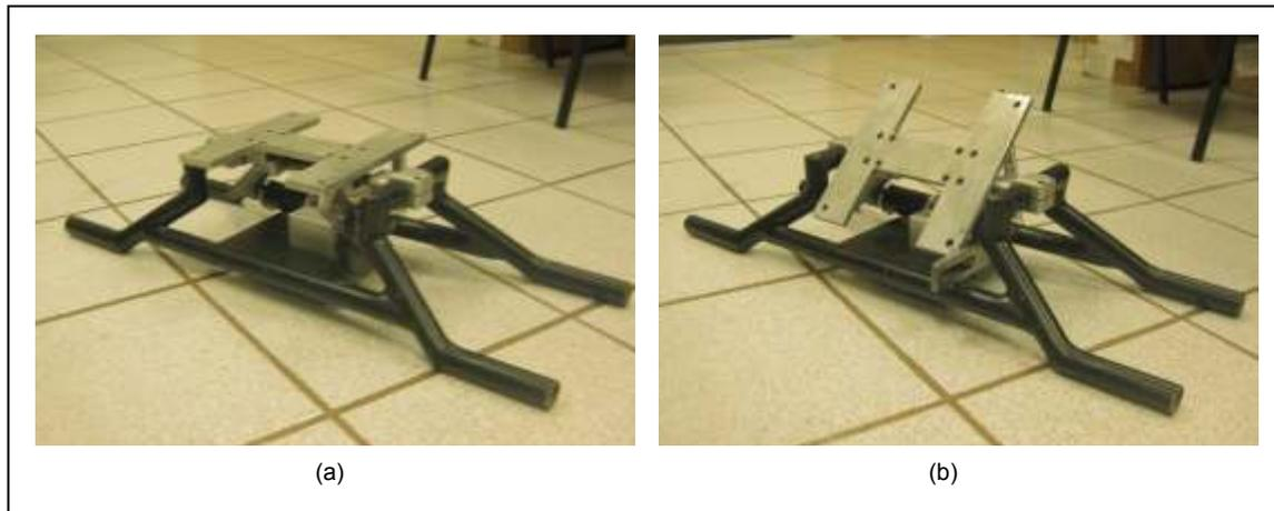
Fig. 4. 8. Prototipo construido. (a) Posicionado en  $\theta = 0^\circ$  (b) Posicionado en  $\theta = 43^\circ$ .
