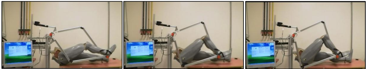
Figura 10.8 Fotografías del dispositivo ejecutando el ejercicio de trayectoria lineal (ejercicio C) en el maniquí.
