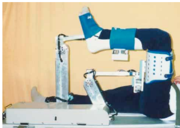
Figura 2.6 Máquina de ejercicios terapéuticos para la rodilla TEM (Therapeutic Exercise Machine) [39].
