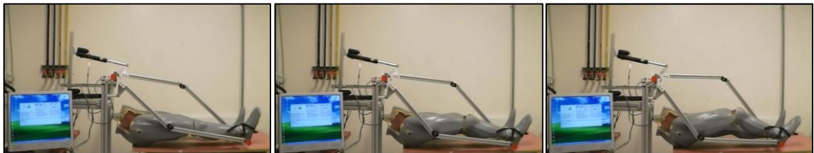
Figura 10.10 Fotografías del dispositivo reubicando la pierna del maniquí para dar inicio a la ejecución de un nuevo ejercicio.
