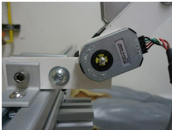
Figura 8.11 Fotografía del montaje del encoder en la articulación activa del brazo de derecho del mecanismo.
