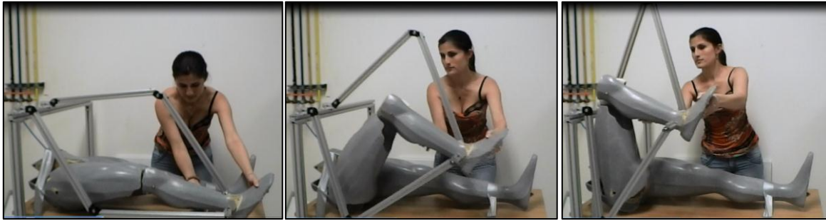
Figura 8.10 Fotografía del mecanismo al aplicar el ejercicio de elevación de la pierna con flexoextensión en rodilla y cadera. (Ejercicio D).
