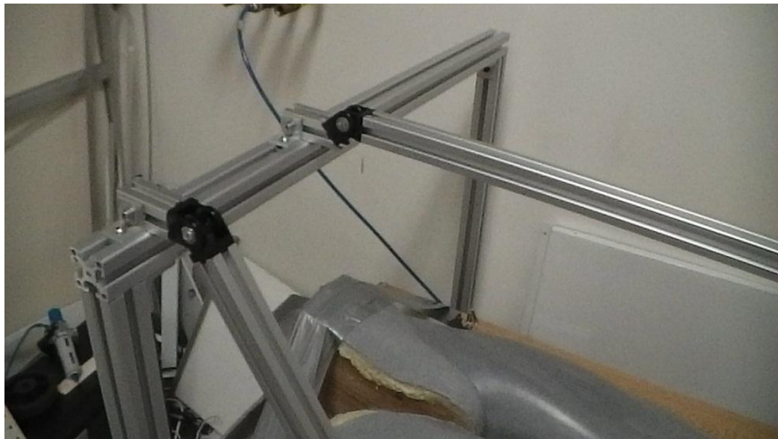
Figura 8.3 Fotografía de la unión de los brazos del mecanismo a la base.
