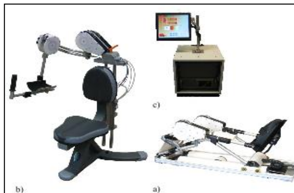
Figura 2.2 Prototipo de terapia de movimiento para a) rodilla, b) hombro, c) unidad de control (Univ. of Bremen) [25].
