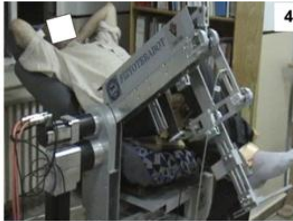
Figura 2.5 Robot manipulador para la rehabilitación de la rodilla [38].
