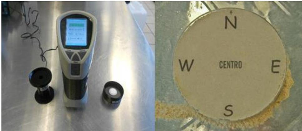
Figura 15. De lado izquierdo: Colorímetro utilizado. Lado derecho: Distribución de los puntos de lectura en la caja Petri.
