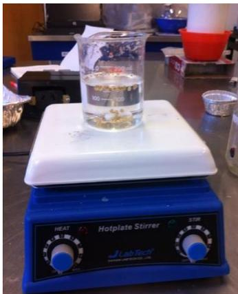
Figura 8. Granos flotantes en la solución de nitrato de sodio.
