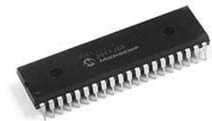
Figura 2.16.- PIC18f4550 empaquetado DIP-40
