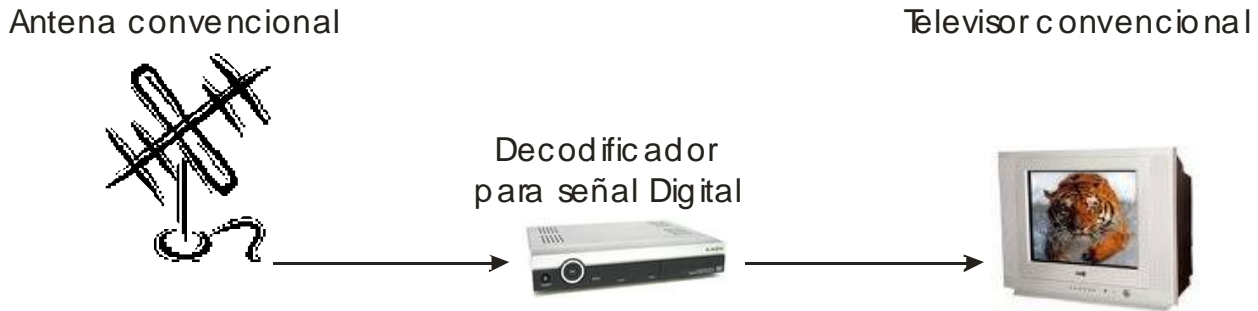
Fig. 1.12 Recepción de señal Digital con STB (Decodificador)
