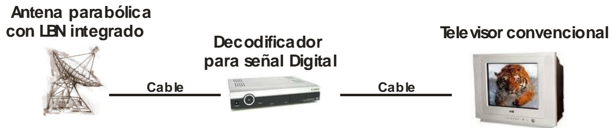
Fig. 1.16 Diagrama para recibir señal digital vía satélite a televisor analógico.
