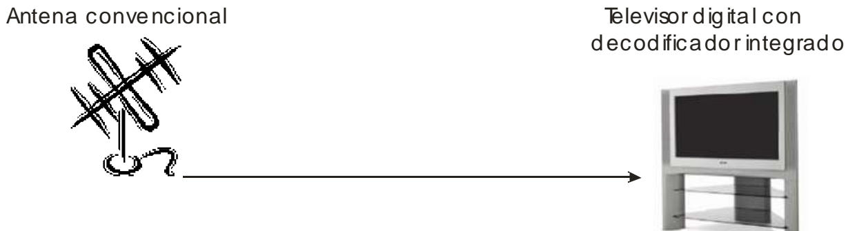
Fig. 1.13 Recepción de señal Digital con STB (Decodificador) Integrado
