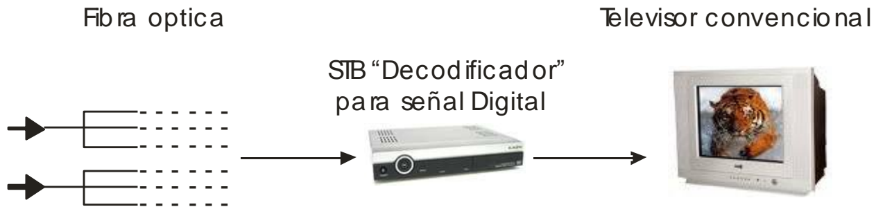
Fig. 1.14 Diagrama de señal digital por cable.
