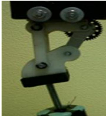
Figura 4.6.- Servomecanismo en un ángulo 135°.
