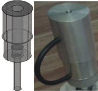
Figura 3.24.- Prototipo de amortiguador y pistón ensamblado [43].
