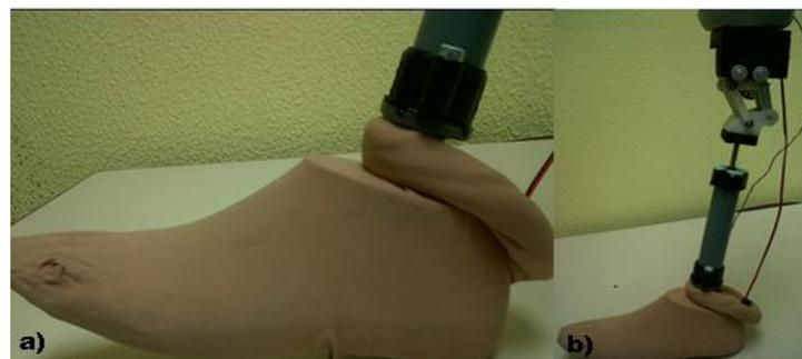
Figura 4.25- Prototipo en fase de impacto final a) Activación del sensor del talón b) Posición del prototipo.
