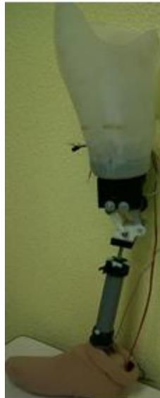
Figura 4.21.- Prótesis de miembro inferior a nivel transfemoral.
