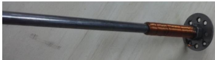
Figura 3.28.- Vástago con la bobina (electroimán).
