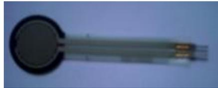
Figura 3.1.- Sensor piezoresistivo (ForceSensingResistors®).
