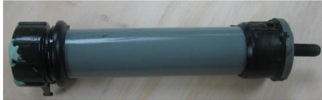
Figura 4.15.- Vista lateral del amortiguador terminado.
