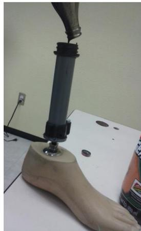
Figura 4.16.- Llenado del amortiguador.
