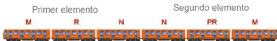
Figura 1. 2 Convoy de rodadura neumática de 2 elementos STC METRO.
