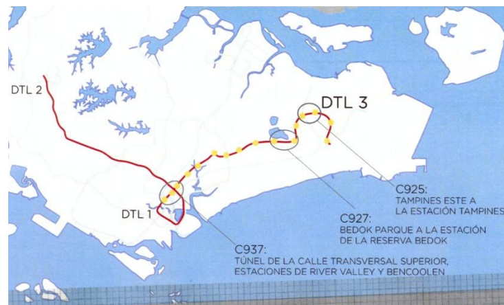
Imagen 2 - 10. Seis EPBs de Robbins empezarán a excavar tres tramos a lo largo de la nueva Línea 3 del centro de la ciudad (DTL3) de Singapur en el 2012 y 2013.
