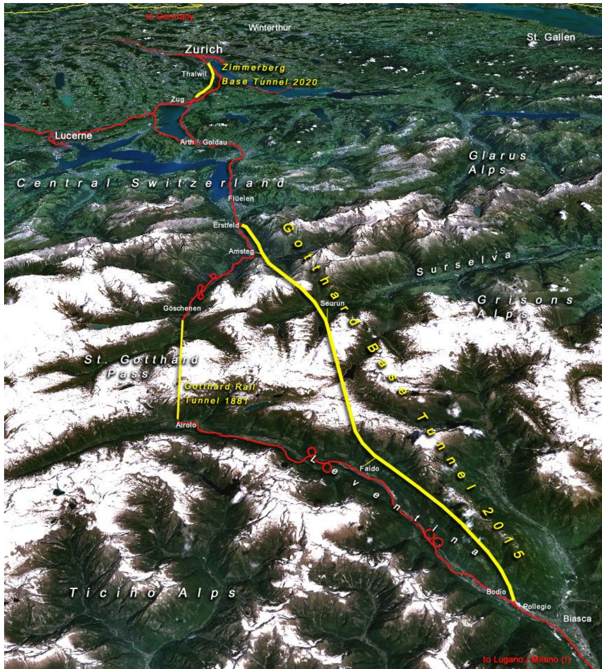
Imagen 2 - 8. El nuevo Túnel de base San Gotardo junto con el Túnel de base Zimmerberg forman la parte norte de eje San Gotardo del proyecto Alptransit (amarillo: túneles principales - rojo: trazados ferroviarios actuales - números: año de finalización).
