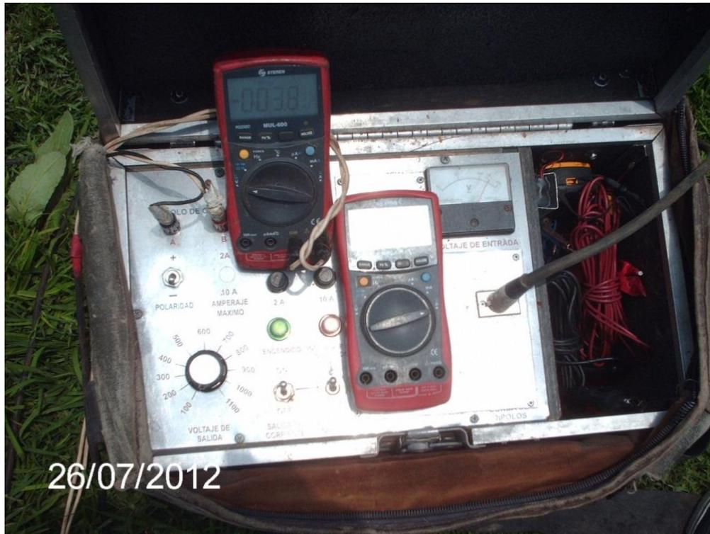
Fig. 4.2 Resistivímetro usado para la adquisición de datos eléctricos
