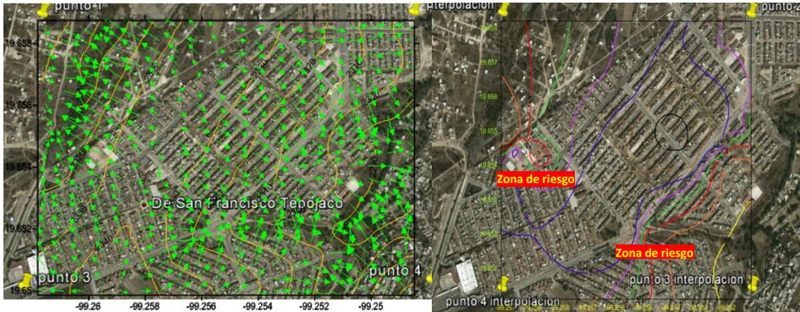
Fig. 4.34 Dirección del escurrimiento de aguas por gravedad y mapa de profundidad de la capa firme.
