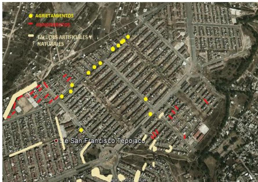
Fig. 2.8 Agrietamientos, hundimientos y taludes encontrados en el reconocimiento del lugar (Salazar L., Mondragón R., López M., 2011)
