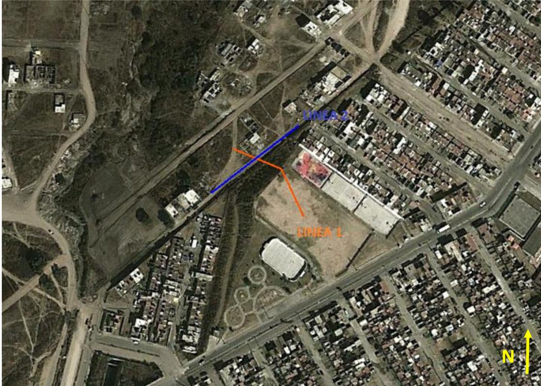
Fig. 4.1 Ubicación de las líneas de dipolos eléctricos
