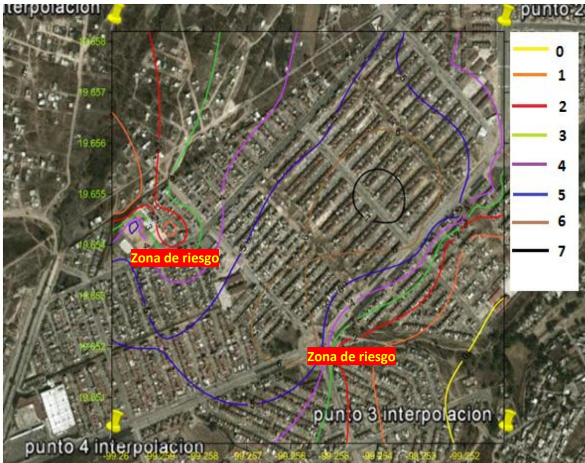
Fig. 4.25 Malla generada a partir de los datos de profundidad de la capa blanda
