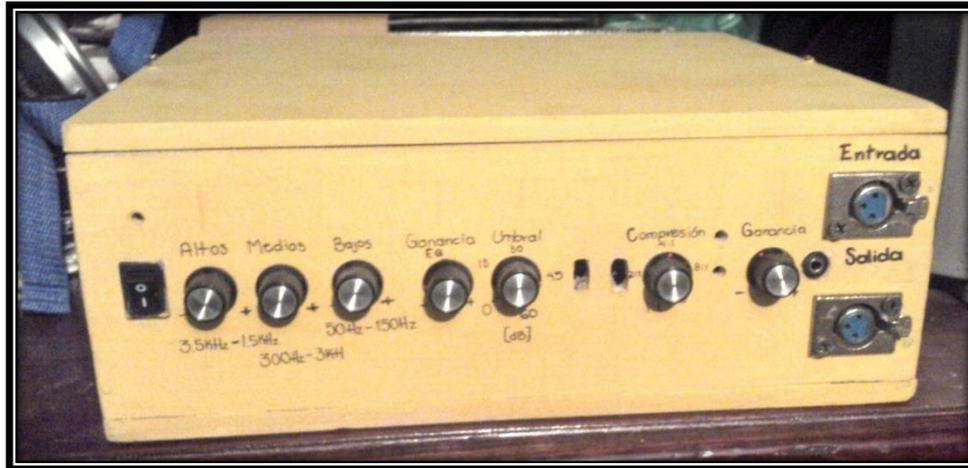
**Figura 65** Sistema de monitoreo terminado parte frontal.
