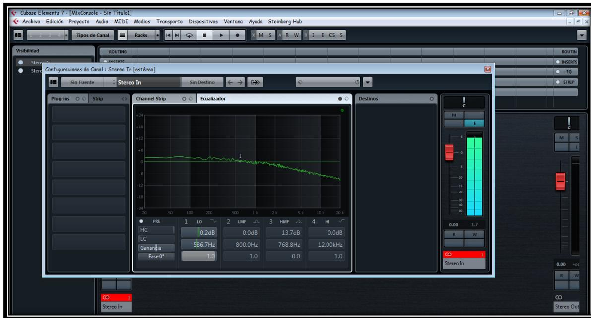
**Figura 63** Vista en el software del ruido rosa procesado a través del ecualizador y compresor de audio.
