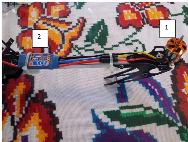
Figura 5.1 Conexión final entre los motores y los ESC
