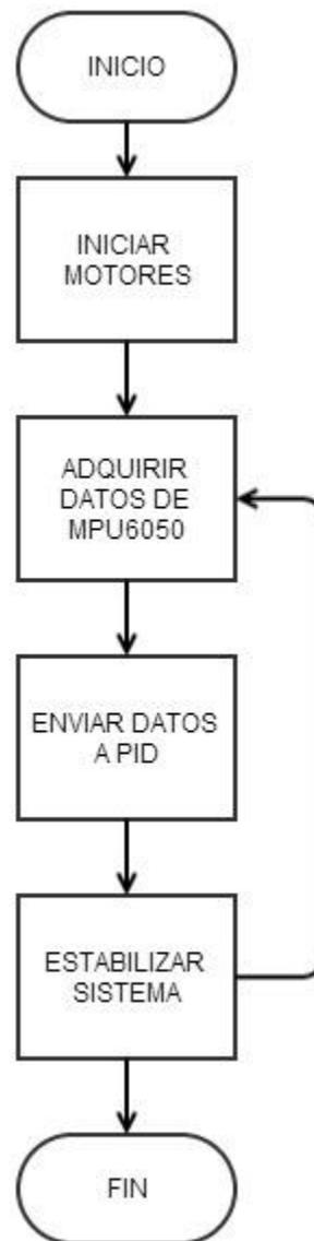
Figura 4.6 Diagrama de flujo para el control de los motores
