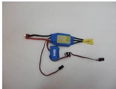
Figura 2.11 Variador de velocidad para motores CC
