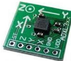
Figura 2.10 Acelerómetro electrónico
