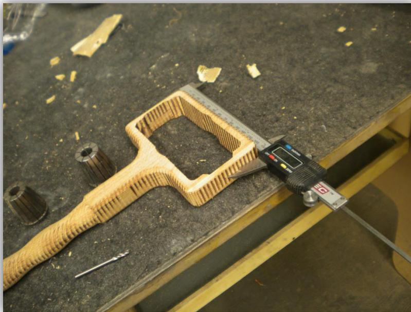
Figura 35 Inspección de medidas
