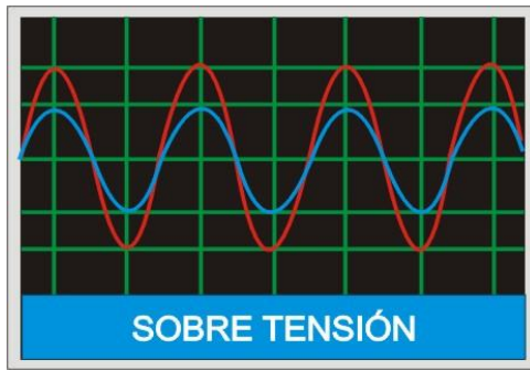
Figura 1.7 Sobretensión. Normalmente producidas por cambios de cargas eléctricas e interruptores de conexión de la compañía eléctrica. Esto produce graves daños en los circuitos electrónicos además de varios problemas del equipo informático.
